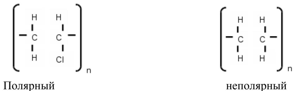
Рисунок 3. Пример полярного и неполярного полимера
