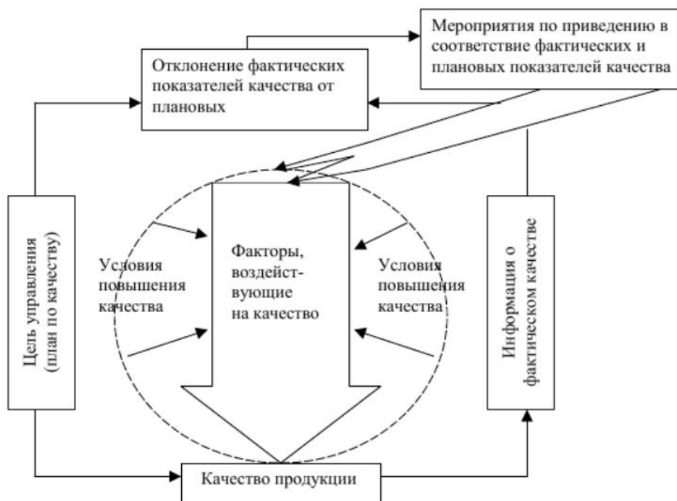
Рисунок 2 – Схема механизма управления качеством продукции
