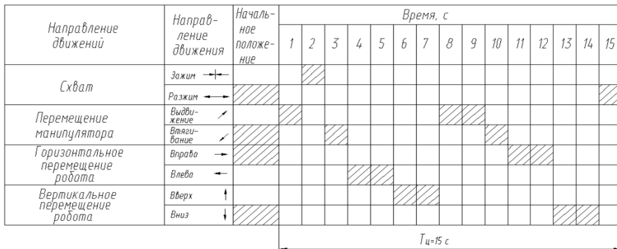
Рисунок 3.4. Циклограмма работы промышленного робота ПР5-2Э-5.4.3.-16-0.5 (пример)
