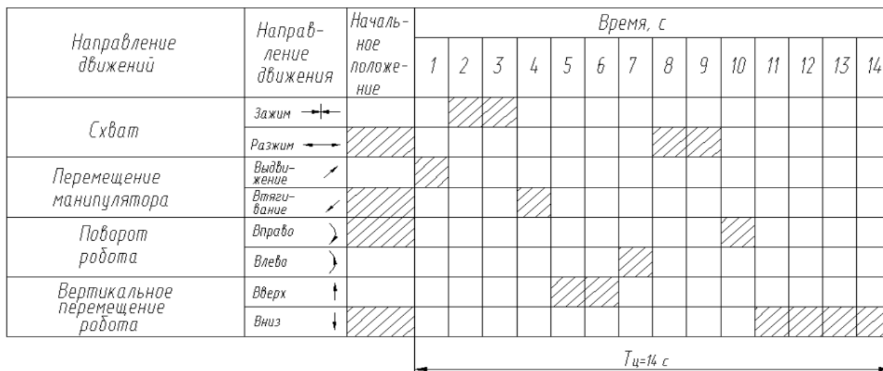
Рисунок 3.5. Циклограмма работы промышленного робота ПР5-2Э-13.4.3.-16-0.5 (пример)
