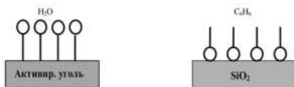
Рисунок 2.30. Ориентация молекул ПАВ на границе раздела: активированный уголь (неполярный адсорбент) – вода (полярный растворитель); силикагель (полярный адсорбент \text{SiO}_2 ) – бензол (неполярный растворитель)
