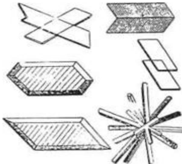
Рисунок 5 – Кристаллы сернокислого кальция  $\text{CaSO}_4$  под микроскопом
