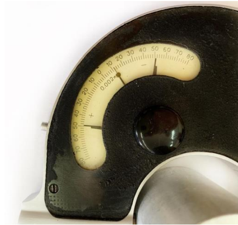
Рисунок 8. Измерение отклонения размера наружной поверхности от настроечного размера
