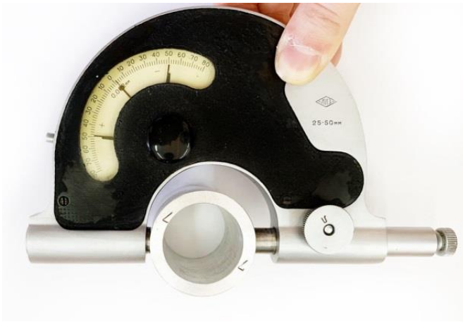
Рисунок 8. Измерение отклонения размера наружной поверхности от настроечного размера
