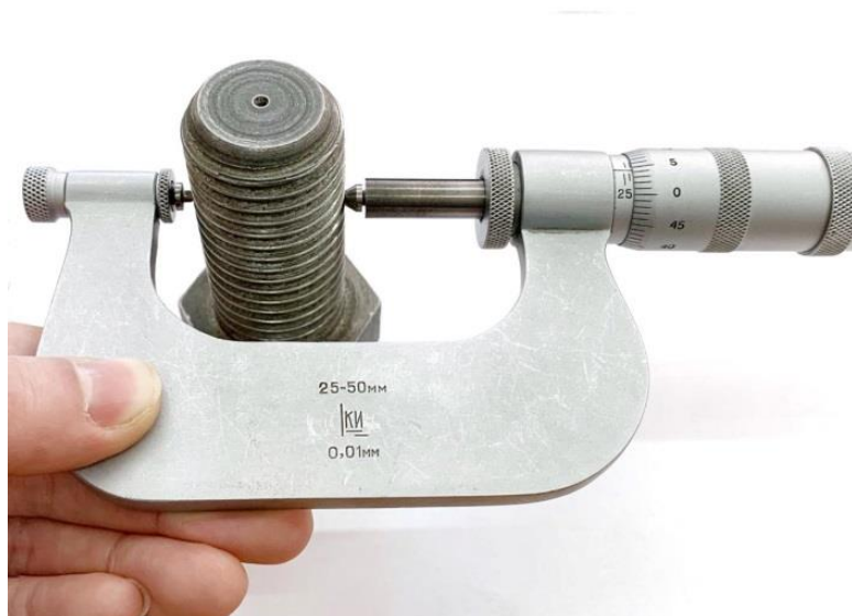
Рисунок 28. Установка вставок в резьбу
