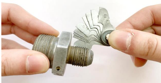
Рисунок 26. Определение угла профиля и шага резьбы резьбовым шаблоном
