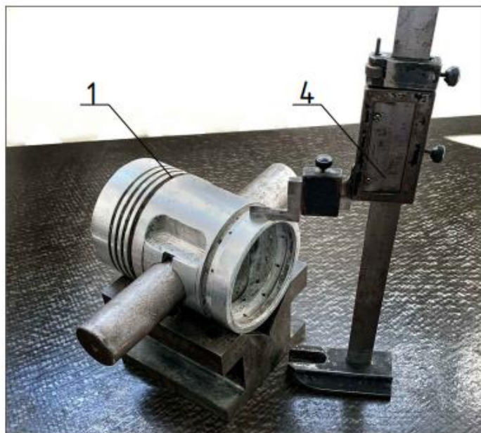
Рисунок 20. Измерение высоты образующей поршня над плитой
