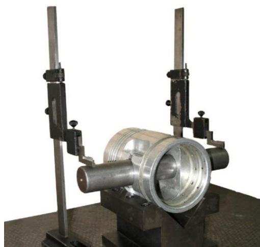
Рисунок 18. Базирование поршня при измерении
