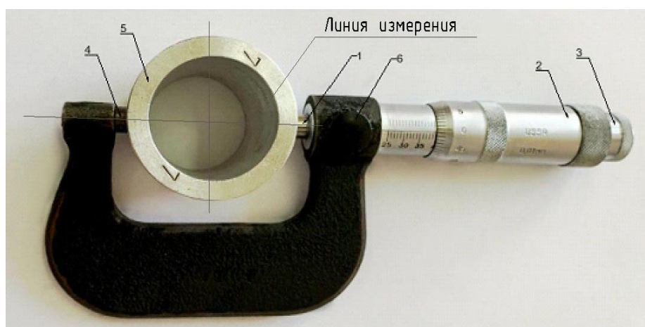
Рисунок 28. Измерение микрометром наружного диаметра втулки:
