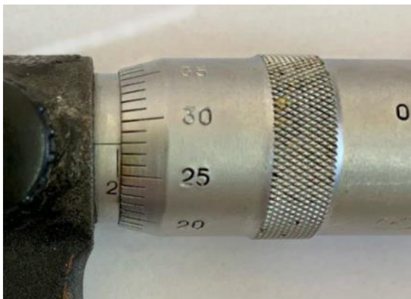
Рисунок 25. Неправильная установка микрометра в нулевое положение
