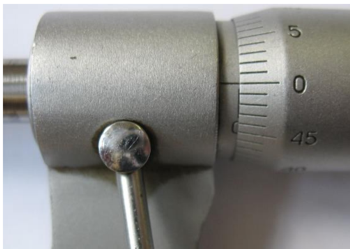
Рисунок 24. Установка микрометра на нуль проведена правильно
