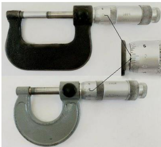
Рисунок 23. Проверка нулевого положения микрометра
