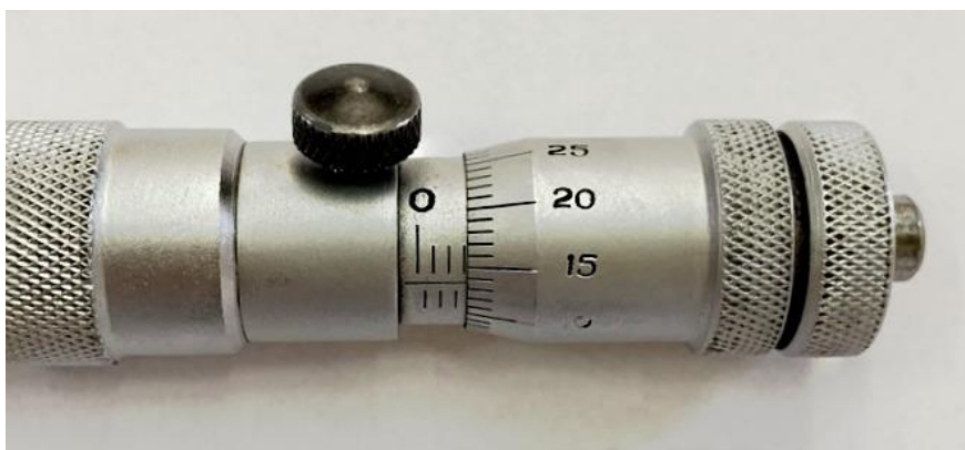
Рисунок 37. Пример отсчёта по шкалам нутромера
