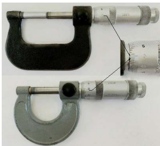
Рис. 23. Проверка нулевого положения микрометра
