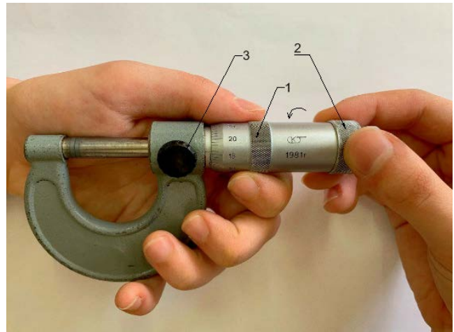
Рис. 27 – Установка барабана на нуль
