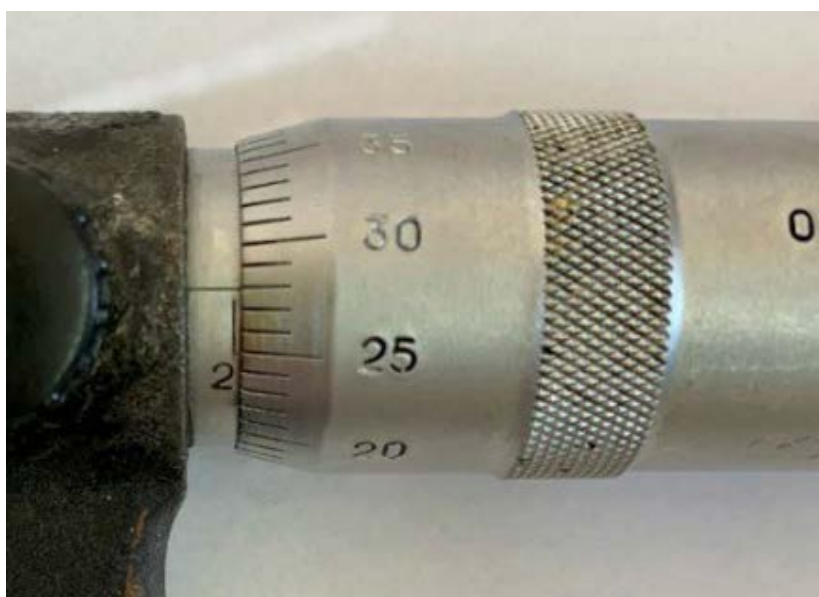
Рис. 25. Неправильная установка микрометра в нулевое положение
