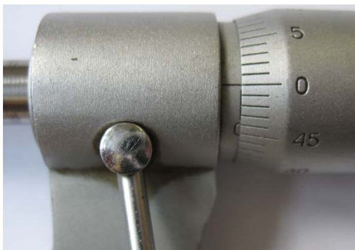
Рис. 24. Установка микрометра на нуль проведена правильно
