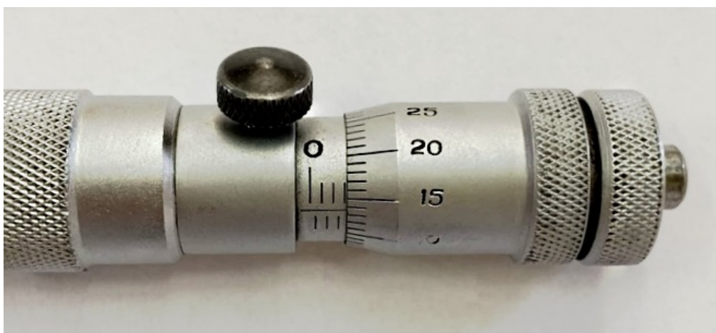
Рис. 37. Пример отсчёта по шкалам нутромера
