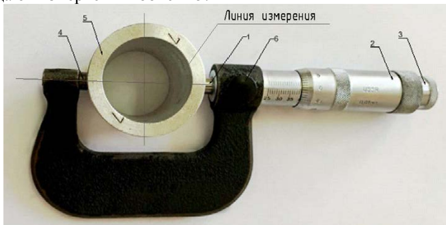
Рис. 28. Измерение микрометром наружного диаметра втулки: 1 – микровинт; 2 – барабан; 3 – трещотка; 4 – пятка; 5 – деталь; 6 – стопорный винт
