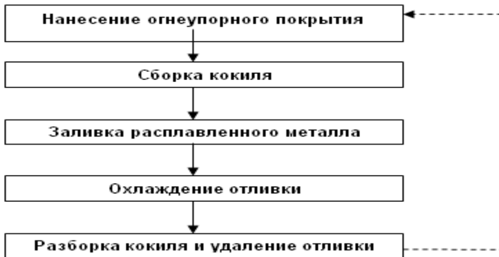
Рисунок 2.3 – Схема технологического процесса (цикл) литья в кокиль
