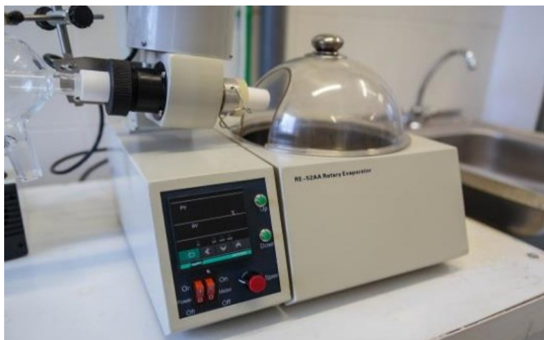
Рисунок 3.2 – Вакуум-выпарной аппарат для концентрирования растворов
