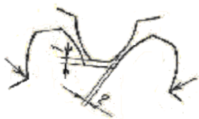
Рисунок 6 – Проверка радиального и бокового зазоров с помощью проволоки
