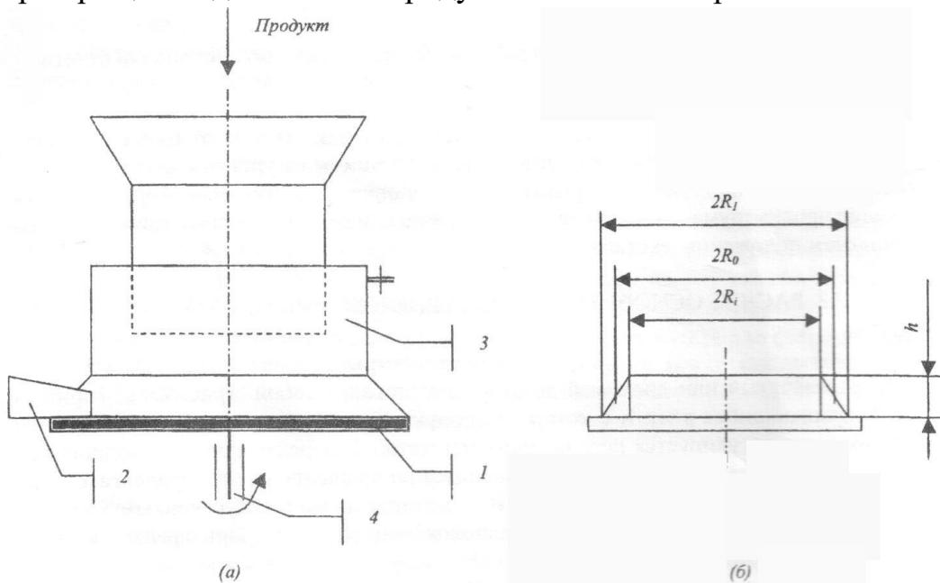
Рис. 2.4 Тарельчатый или дисковый дозатор (а), максимальный объём продукта, снимаемого за один оборот (б)
