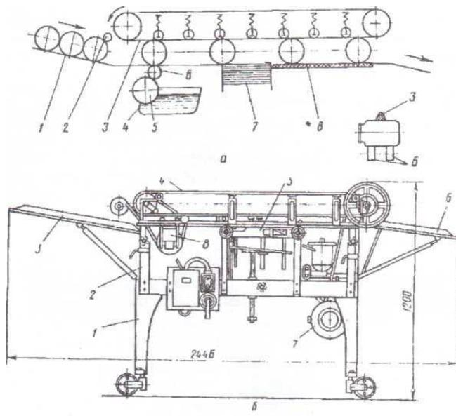
Рис. 3.1 Линейная этикетировочная машина:
