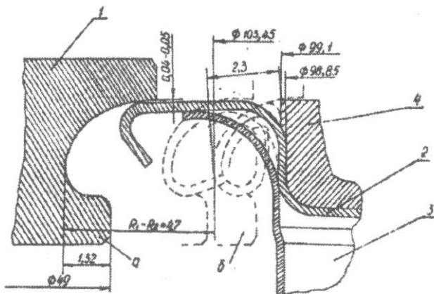
Рис. 4.5 Первая операция: а - начало операции; б - конец операции; I - ролик; 2 - крышка; 3 - корпус; 4 - верхний патрон
