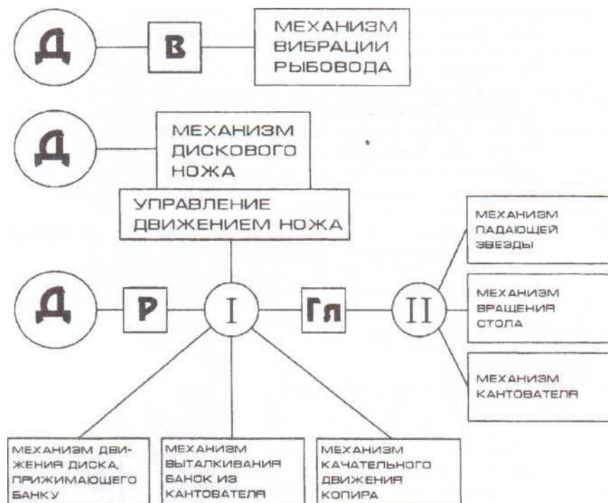
Рис. 6.1 Структурная схема машины ИНА-115
