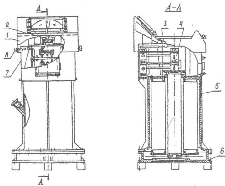
Рис. 1.6 Весоконтрольное устройство Н2-ИВА-401
