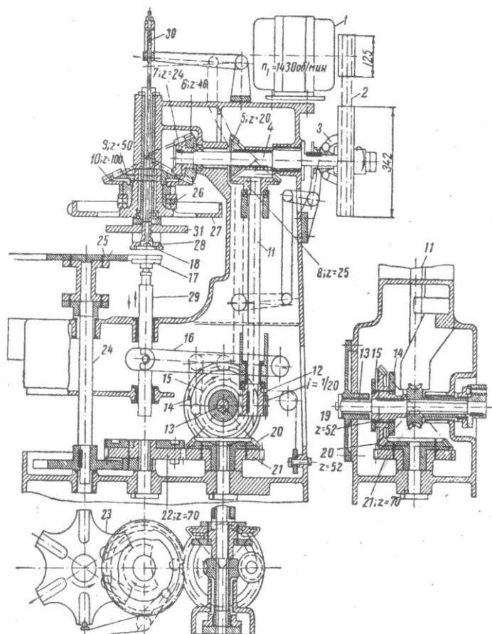
Рис. 4.4 Кинематическая схема закаточной машины БЧ-43Т-13А
