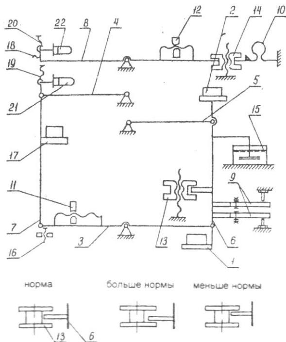
Рис.1.8 Кинематическая схема преобразователя автомата Н2-ИВА-108
