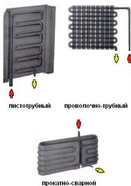
Рис.14 Воздушные конденсаторы бытовых холодильников
