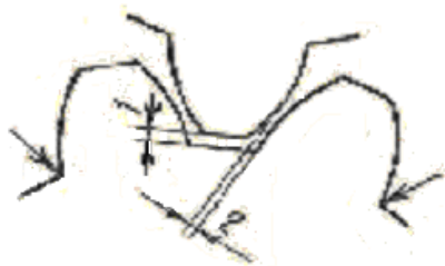
Рис. 6 – Проверка радиального и бокового зазоров с помощью проволоки
