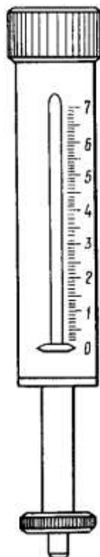
Рисунок П.В.3 – Ручной пенетромтр для замеров зрелости фруктов
