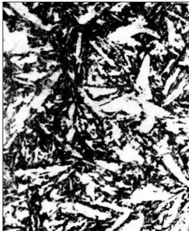
Мартенсит высокоуглеродистой стали с 1,0 % С, \times 1250 [4]
