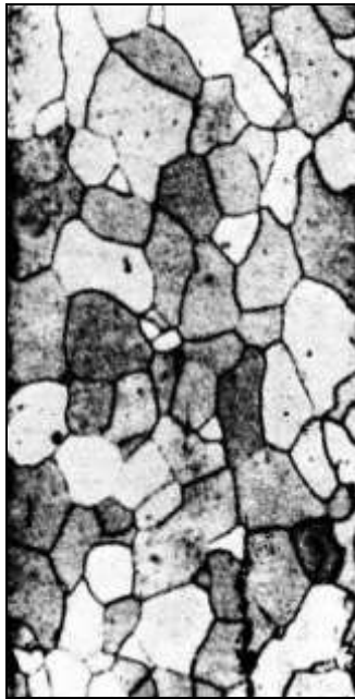
Структура листовой малоуглеродистой стали после рекристаллизационного отжига при температуре 700 °С; \epsilon = 46 \% , зерно измельчается сильнее, \times 100 [4]
