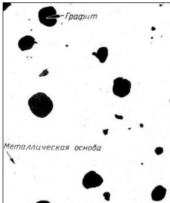
Высокопрочный чугун с шаровидным графитом; шлиф без травления, \times 200 [4]
