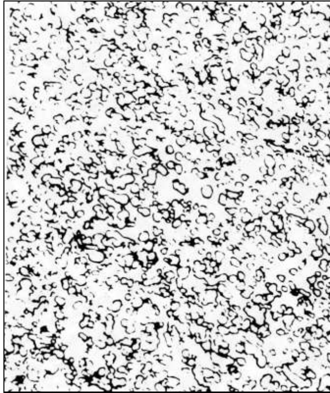
Зернистый перлит в эвтектоидной стали У8; округлые зёрна цементита в ферритной матрице, \times 200 [4]
