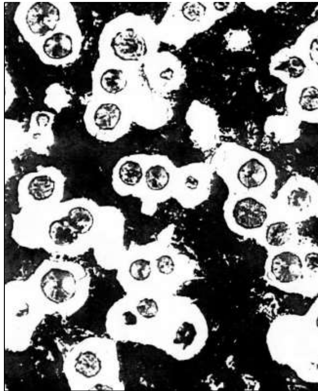
Высокопрочный чугун на ферритно-перлитной основе, \times 200 [4]
