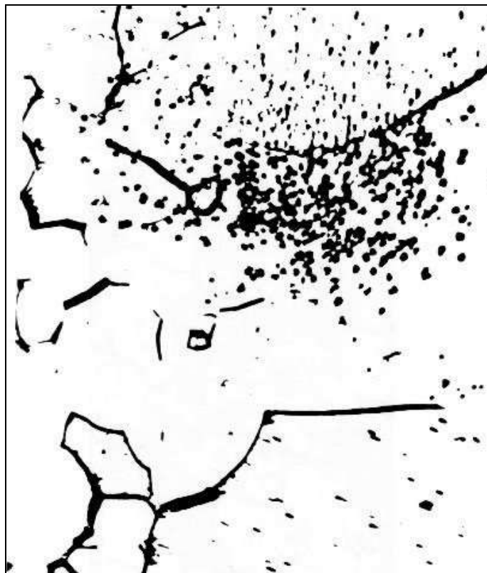
Структура листовой малоуглеродистой стали после рекристаллизационного отжига при температуре 700 °С; \epsilon = 46 \% , зерно измельчается сильнее, \times 100 [4]
