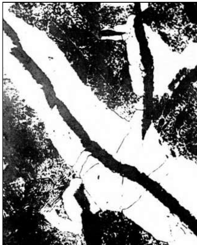
Серый чугун на ферритно-перлитной основе типа СЧ 24, \times 400 [4]
