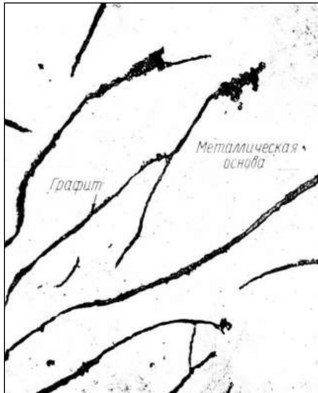
Графитные включения в сером чугуна; шлиф без травления, \times 200 [4]
