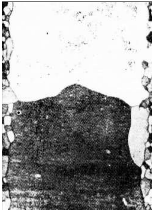
Структура листовой малоуглеродистой стали после рекристаллизационного отжига при температуре 700 °С; после \epsilon = 5\% > \epsilon_{кр} протекает интенсивная рекристаллизация, \times 100 [4]
