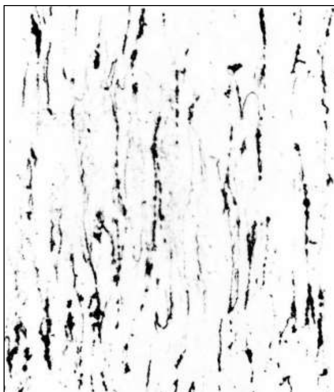
Структура листовая малоуглеродистой стали после холодной пластической деформации, \varepsilon = 46 \% , \times 100 [4]
