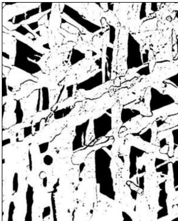
Видманшtedтова структура (структура литой и перегретой стали) в доэвтектоидной стали, \times 200 [4]
