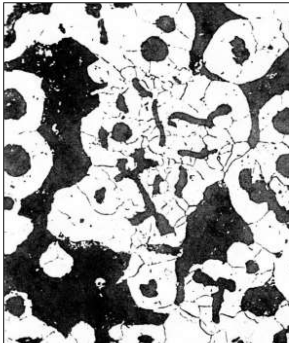
Высокопрочный чугун на ферритно-перлитной основе в условиях недостаточного количества модификатора, \times 200 [4]
