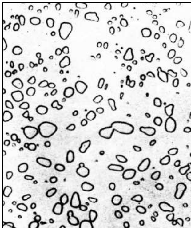
Зернистый эвтектоид стали У8; округлые зёрна цементита в ферритной матрице, \times 1800 [4]
