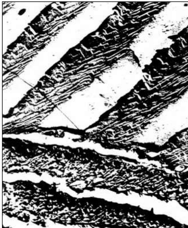
Пластинчатый эвтектоид в стали, \times 5000 [4]
