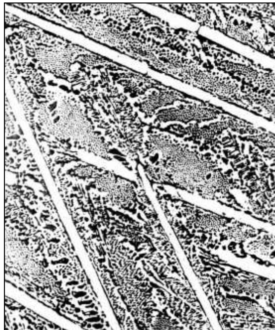
Заэвтектический белый чугун; белые пластины первичного цементита в ледебуритной матрице, \times 100 [4]
