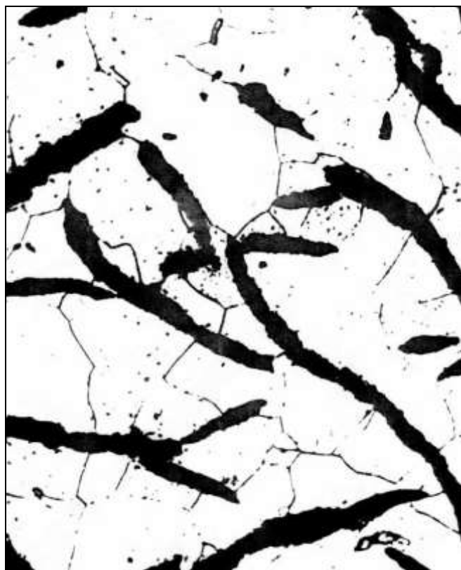
Серый чугун на ферритной основе типа СЧ 12, \times 200 [4]
