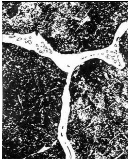
Заэвтектоидная сталь У10; тёмные зёрна перлита, окружённые сеткой вторичного цементита; начальная стадия сфероидизации цементита, \times 800 [4]
