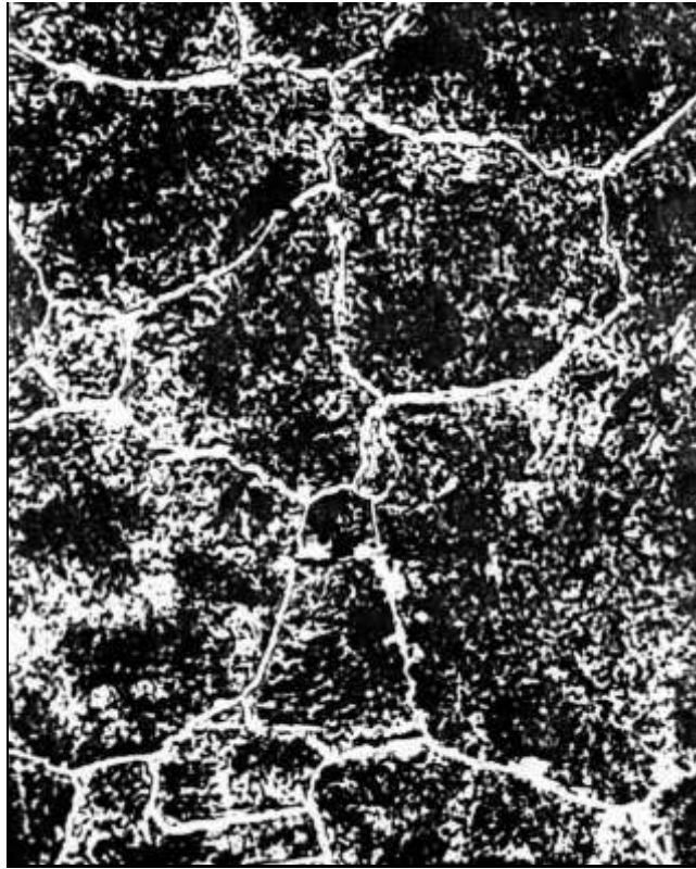
Заэвтектоидная сталь У10; тёмные зёрна перлита, окружённые сеткой вторичного цементита, \times 500 [4]
