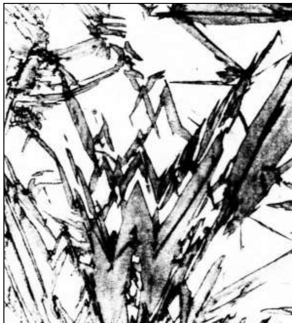
Мартенсит высокоуглеродистой стали с 1,6 % С; тёмные иглы мартенсита, светлые – остаточного аустенита, \times 1500 [4]
