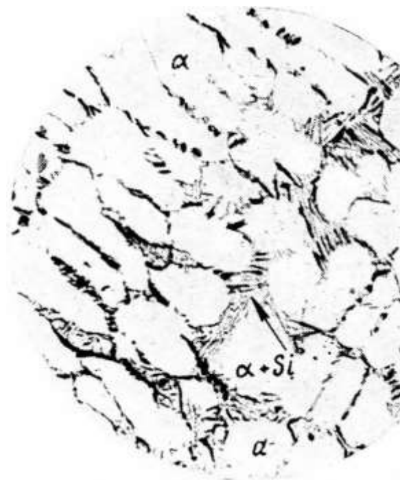
Первичные дендритные кристаллы \alpha -твёрдого раствора в доэвтектическом силумине, \times 200 [4]
