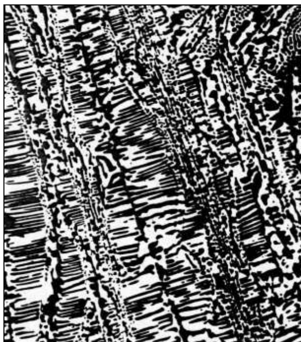
Нормальная стерженьковая эвтектика в эвтектическом белом чугуна, \times 200 [4]
