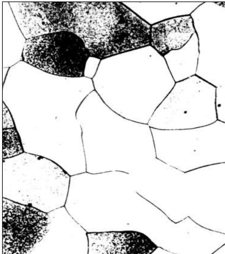
Зёрна феррита в техническом железе, \times 500 [4]
