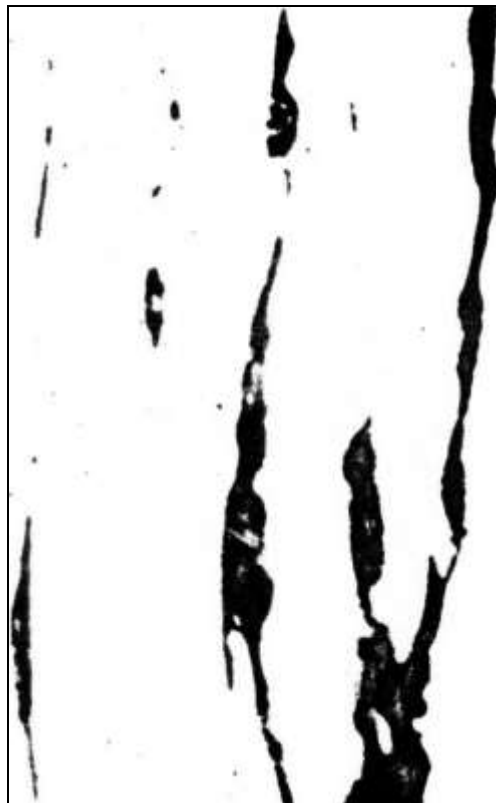
Конструкционная сталь; вытянутые оксисульфиды железа и марганца после деформации прокаткой, \times 1000 [4]
