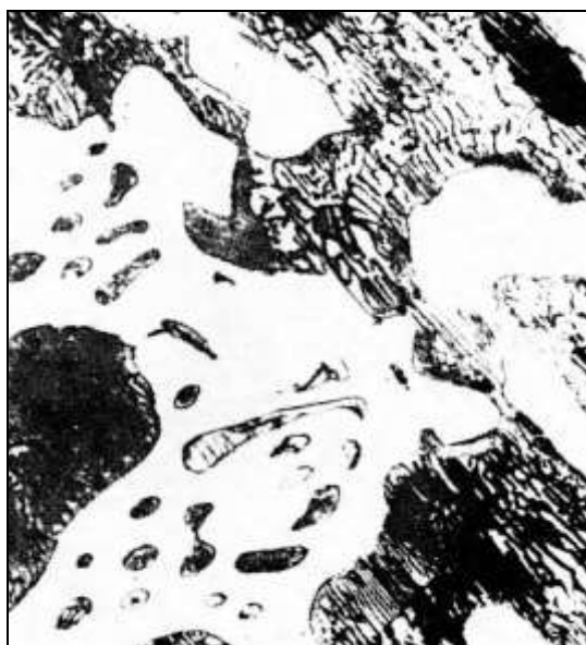
Доэвтектический белый чугун; тёмные дендриты первичного аустенита, превратившегося в перлит при 723^{\circ}\text{C} , вокруг которых – вторичный цементит и эвтектика (ледебурит), состоящая из аустенита (перлита) и цементита, \times 500 [4]
