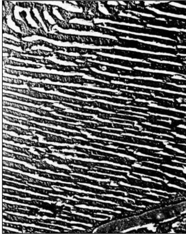
Пластинчатое строение перлита в стали У8, \times 5000 [4]
