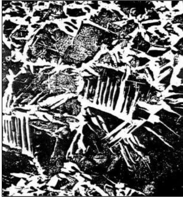
Видманшtedтова структура (структура литой и перегретой стали) в доэвтектоидной стали 60, \times 200 [4]
