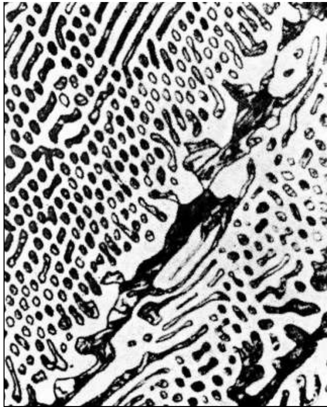
Эвтектический белый чугун; структура: ледебурит (зёрна аустенита (перлита) в цементите), \times 500 [4]
