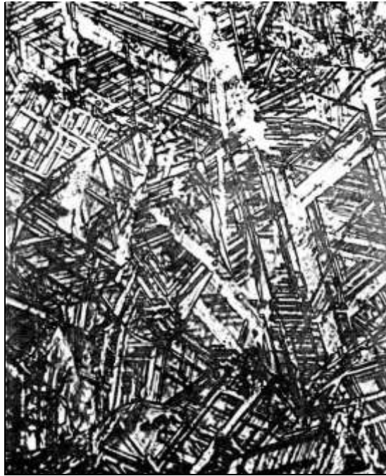
Мартенсит высокомарганцевой стали Г18; пластины s-мартенсита, 500
