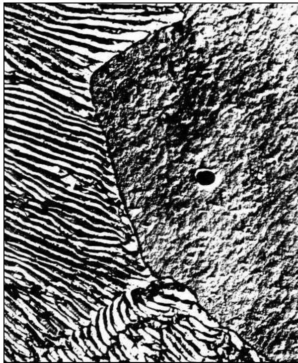
Структура доэвтектоидной стали (феррит, перлит), РЭМ, \times 2500 [4]
