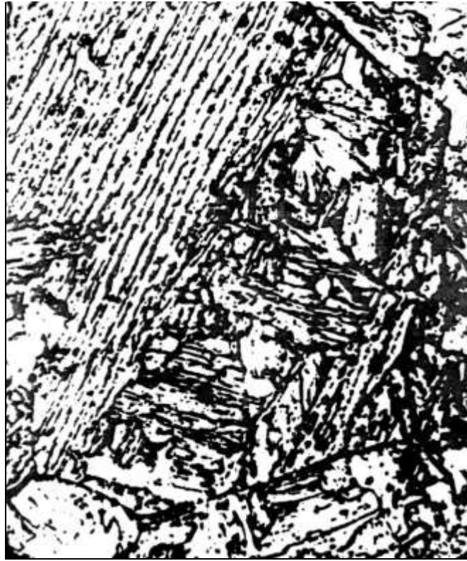
Бейнит малоуглеродистой стали с 0,2 % С, \times 1000 [4]
