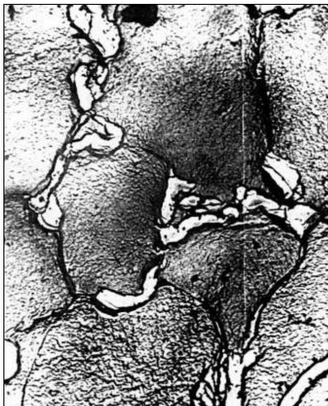
Третичный цементит в техническом железе по границам зёрен, \times 800 [4]
