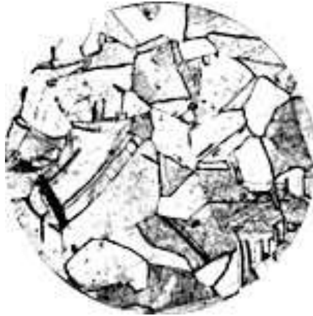
Технически чистая медь М1; равноосные зёрна с двойниками; шлиф перетравлен, \times 260
