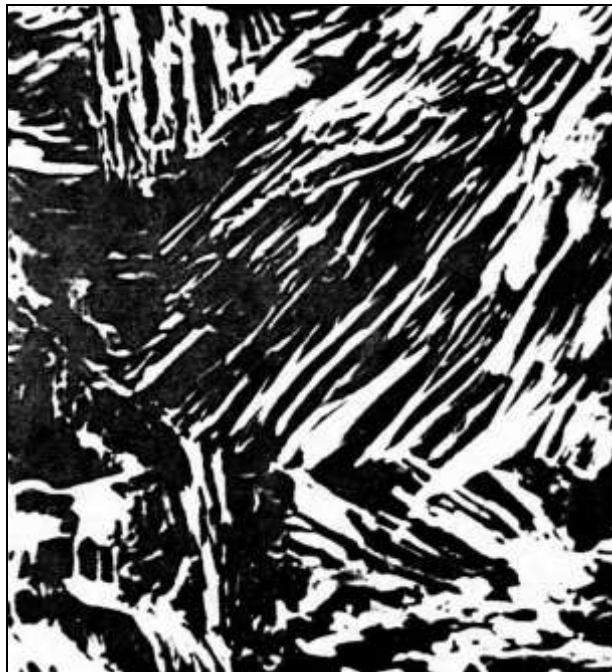
Пластинчатое строение перлита в эвтектоидной стали У8, РЭМ, \times 1000 [4]
