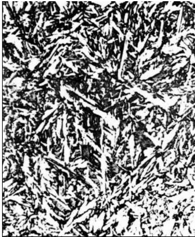
Мартенсит высокоуглеродистой стали с 1,3 % С; тёмные иглы мартенсита, светлые – остаточного аустенита, \times 500 [4]
