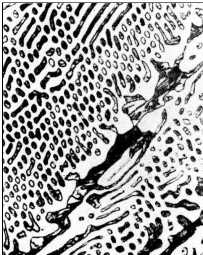
Нормальная сотовая эвтектика в эвтектическом белом чугуна, \times 500 [4]
