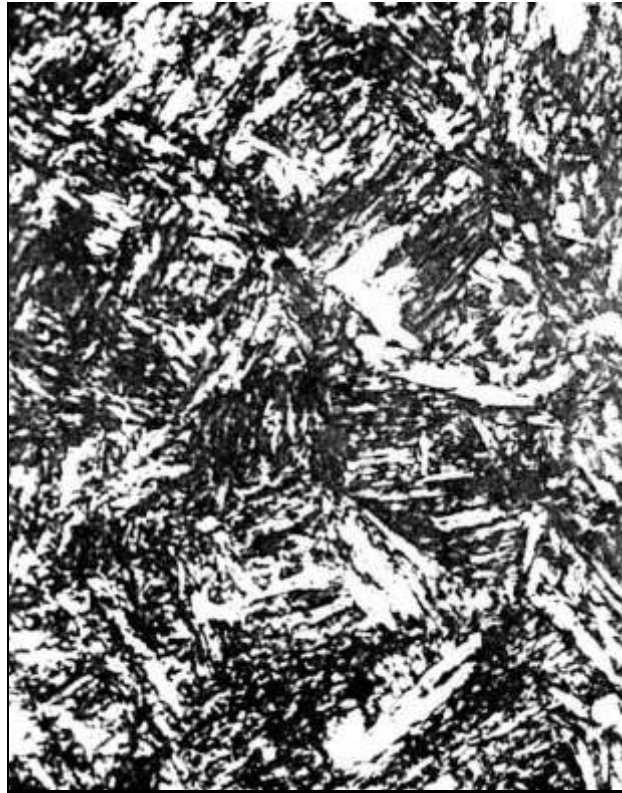
Мартенсит среднеуглеродистой стали с 0,4 % С; рейки мартенсита собраны в пакет, \times 1250 [4]
