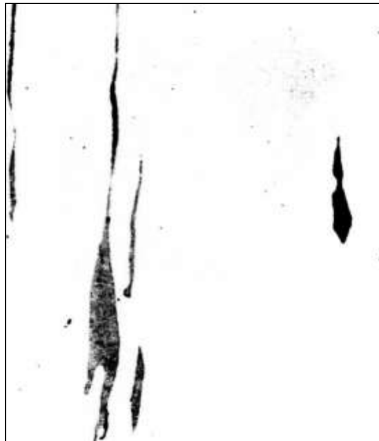
Конструкционная сталь; вытянутые оксисульфиды железа и марганца после деформации прокаткой, \times 1000 [4]
