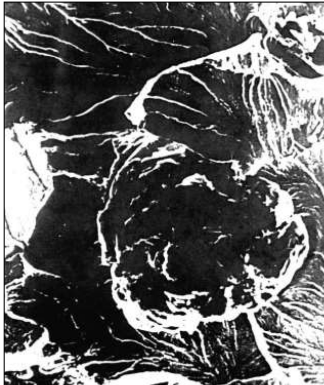
Глобулярный графит в модифицированном высокопрочном чугуна (РЭМ), \times 2500 [4]
