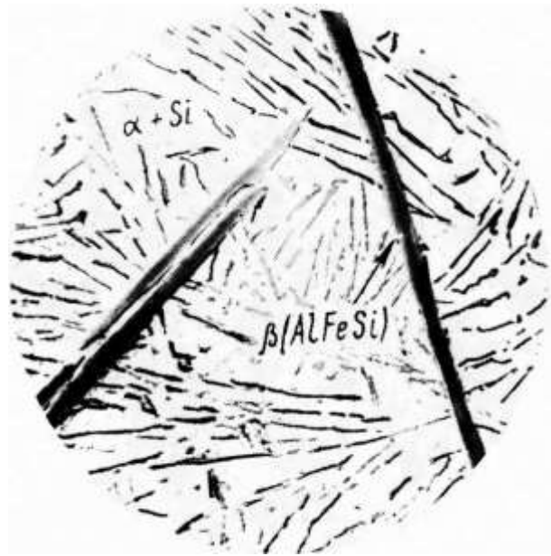
Первичные кристаллы химического соединения P(AlFeSi) в виде игл в немодифицированном силумине, \times 250 [4]
