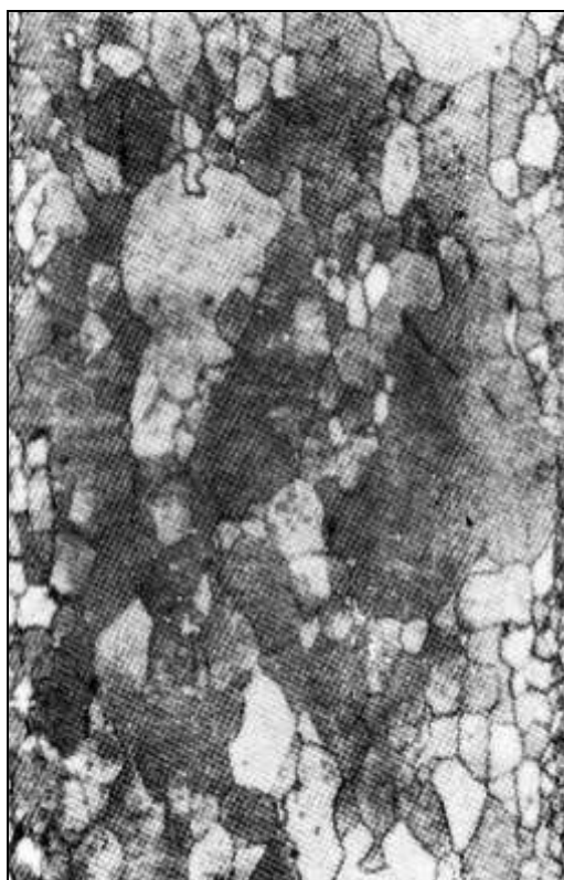
Структура листового малоуглеродистой стали после холодной пластической деформации, \varepsilon = 24\% , \times 100 [4]
