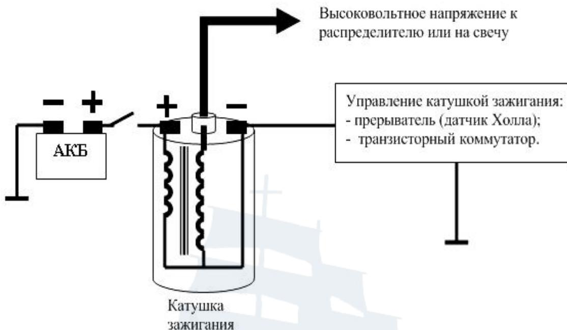
Рис. 4.9. Принципиальная схема катушки зажигания
