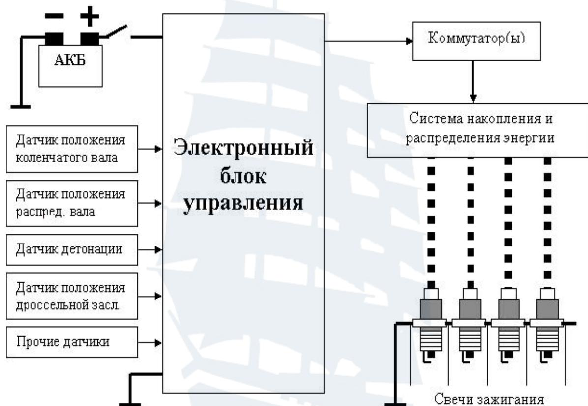
*Рис. 4.8. Принципиальная схема системы зажигания с датчиком Холла и управлением от электронного блока*
