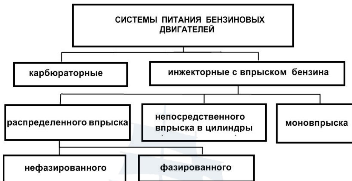
*Рис. 3.1. Классификация способов впрыска бензина*
