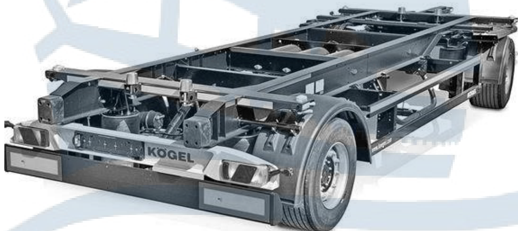
Рис. 10. Прицеп Kögel Combi с разнесенными осями
