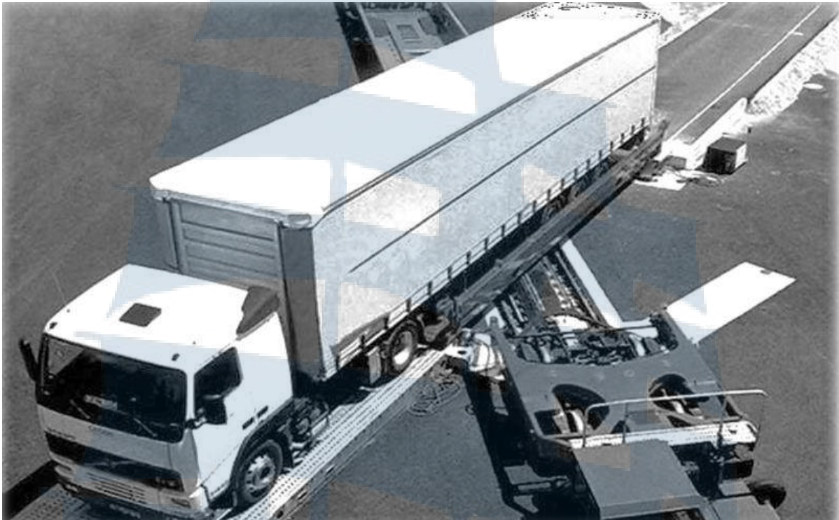
Рис. 31. Погрузка контрейлера на платформу по технологии Modalohr
