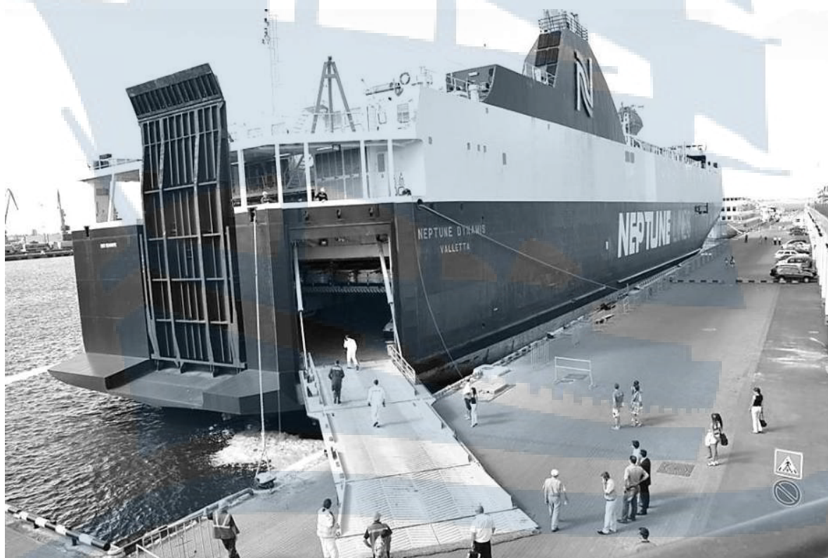
Рис. 135. Паром с кормовой и угловой рампой
