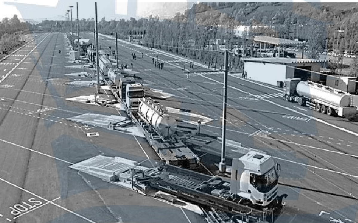
Рис. 32. Погрузка контрейлеров на терминале Modalohr
