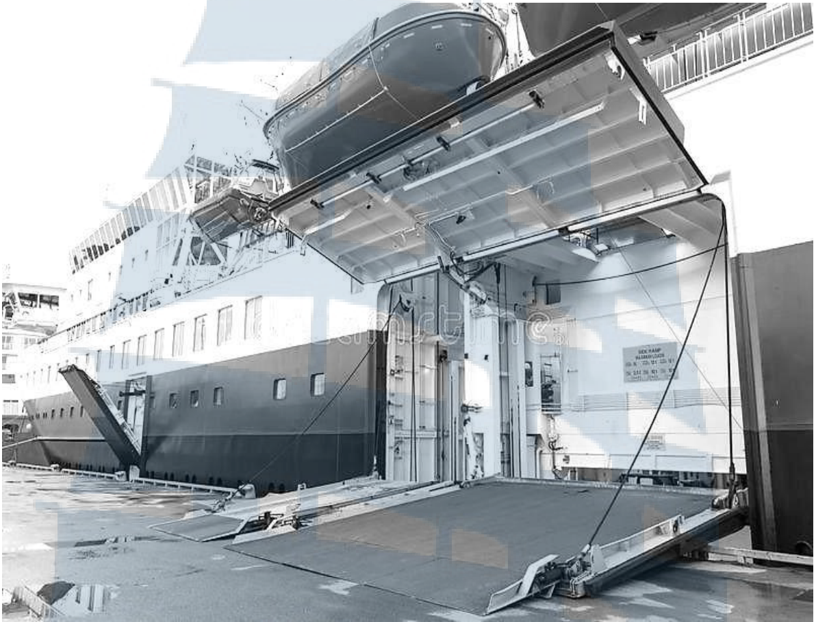
Рис. 136. Паром с бортовой рампой
