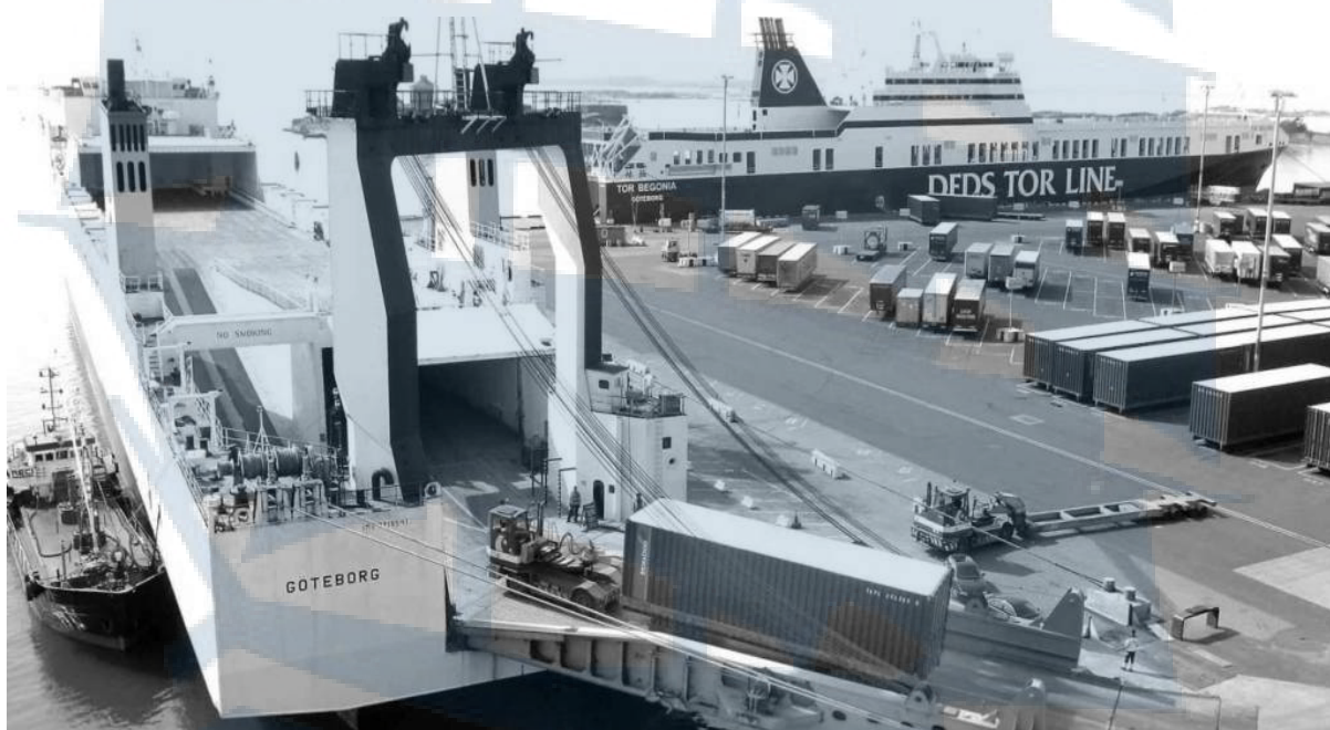
Рис. 139. Загрузка ролкера с кормовой рампой
