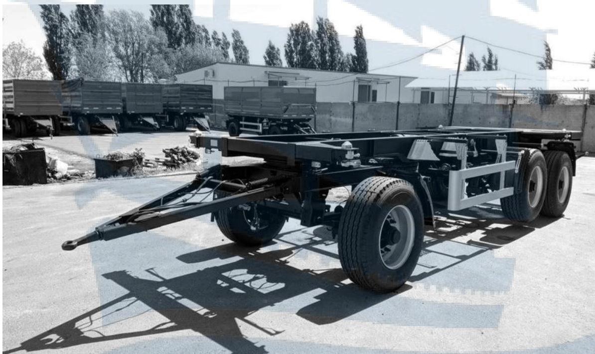
Рис. 74. Трехосный прицеп для перевозки контейнеров
