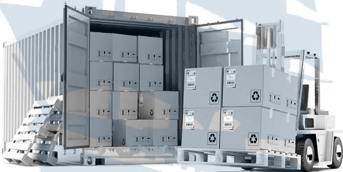
Рис. 161. Размещение пакетов в контейнере
