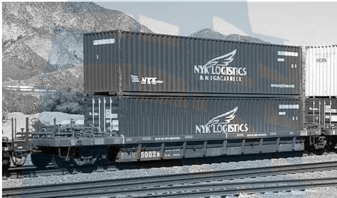
Рис. 44. Железнодорожная двухъярусная платформа
