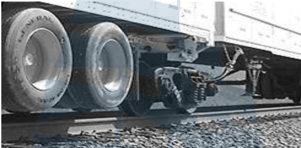
Рис. 41. Автомобильные колеса роудрейлера системы RoadRailer
