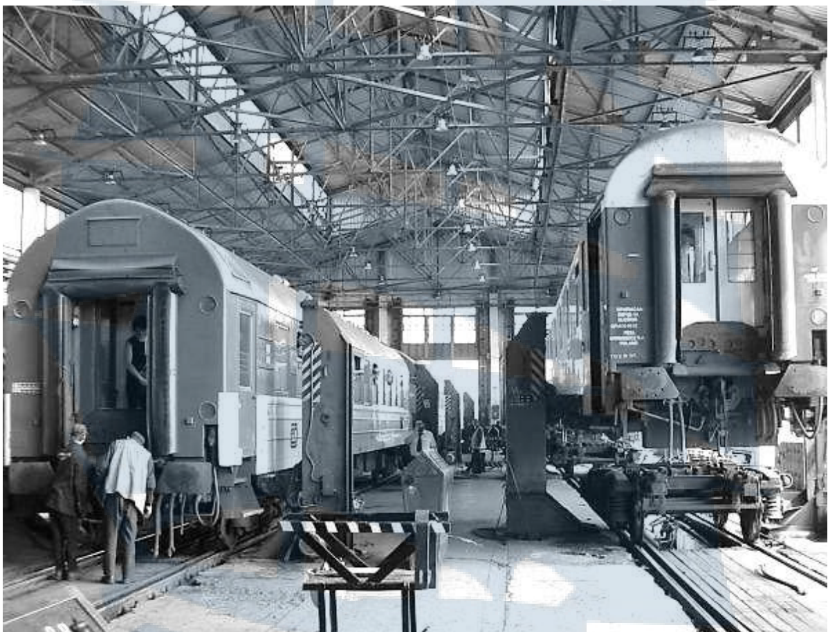
Рис. 53. Перестановка тележек у вагонов
