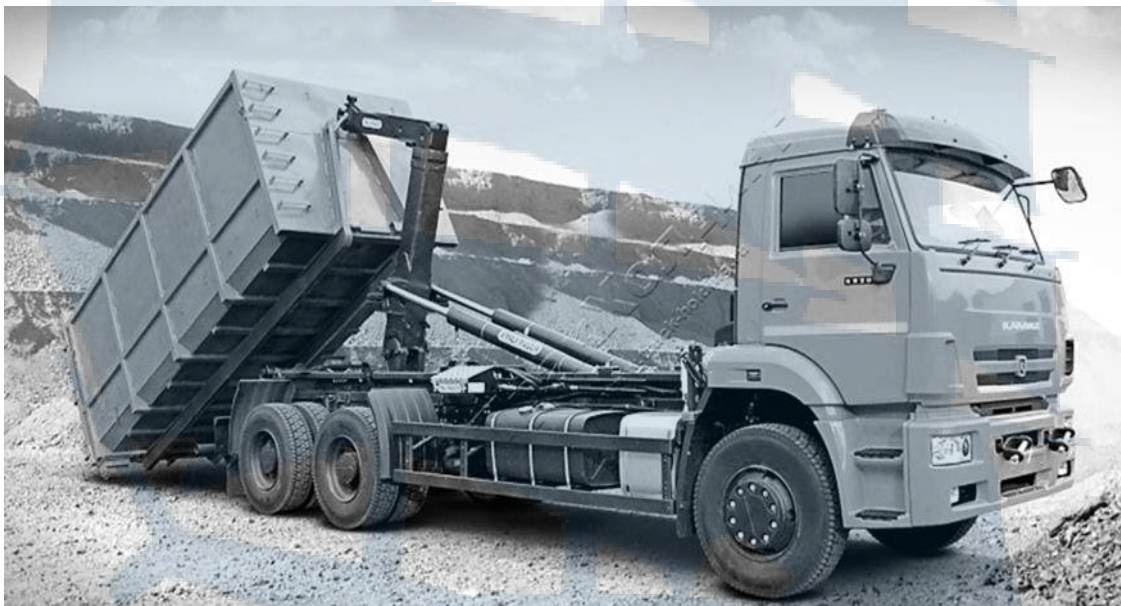
Рис. 7. Погрузка съемного кузова на тягач системой «мультилифт»
