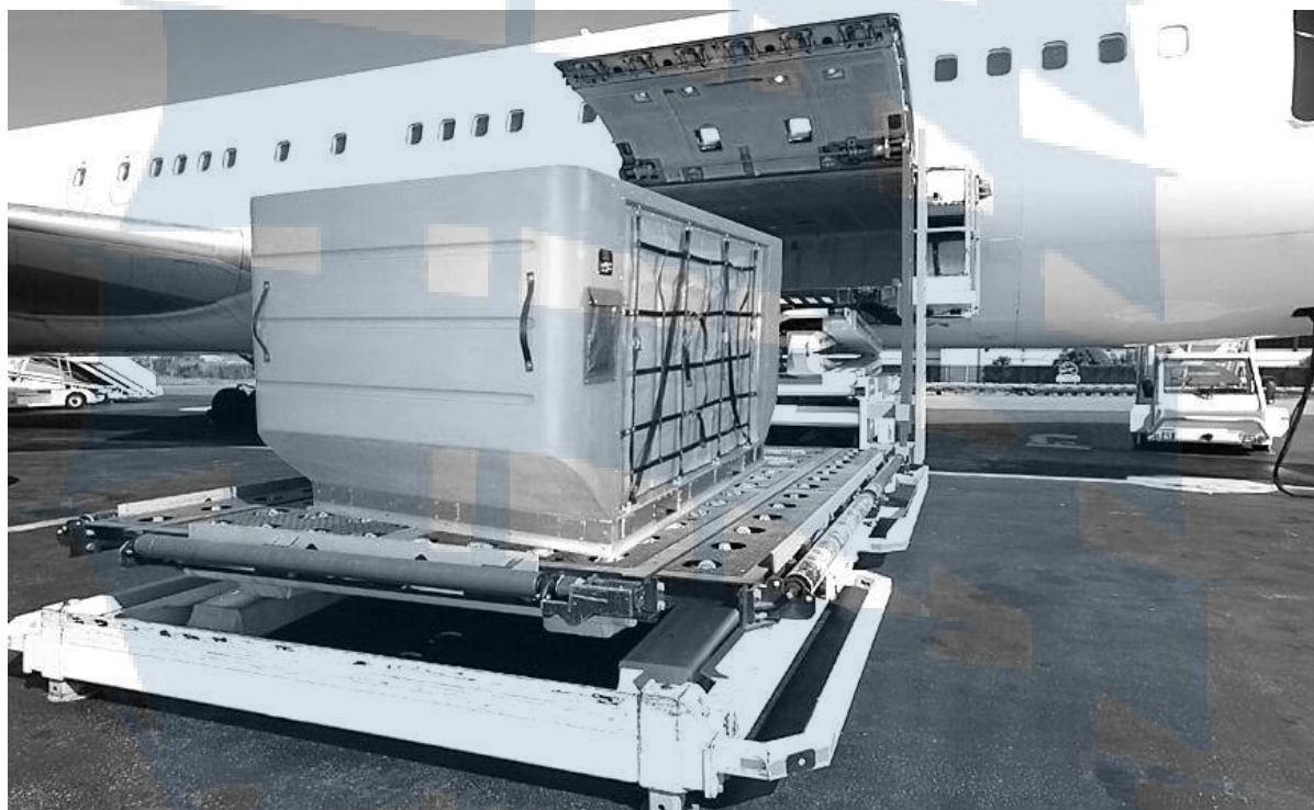
Рис. 150. Загрузка СПГ (контейнер) в самолет
