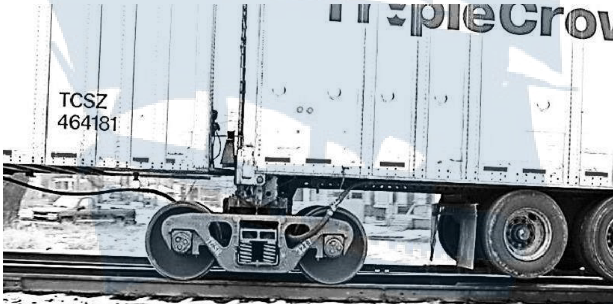
Рис. 40. Вагонная тележка системы RoadRailer
