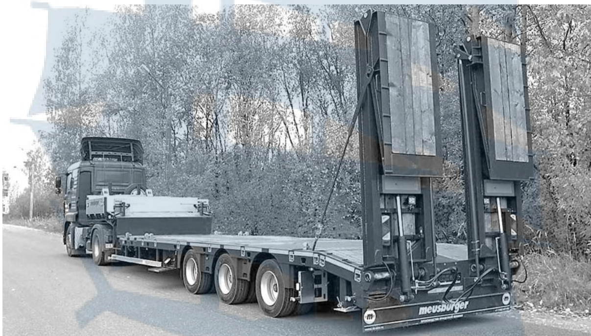
Рис. 18. Трейлер с откидными гидравлическими трапами
