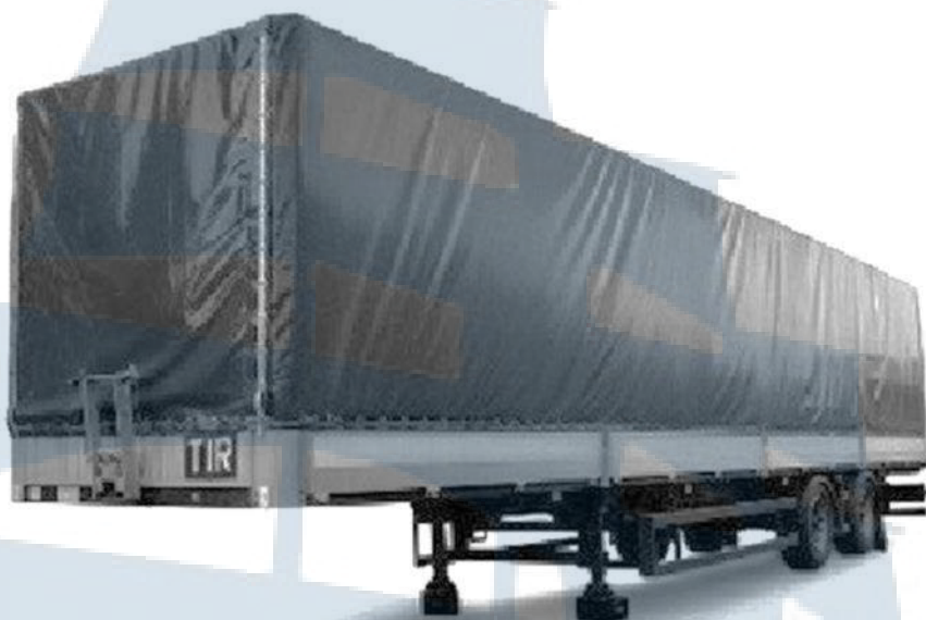
Рис. 2. Съемный кузов – полуприцеп без передних колес
