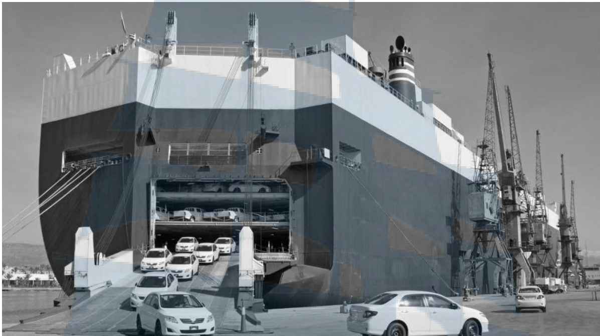
Рис. 138. Выгрузка ролкера с кормовой рампой
