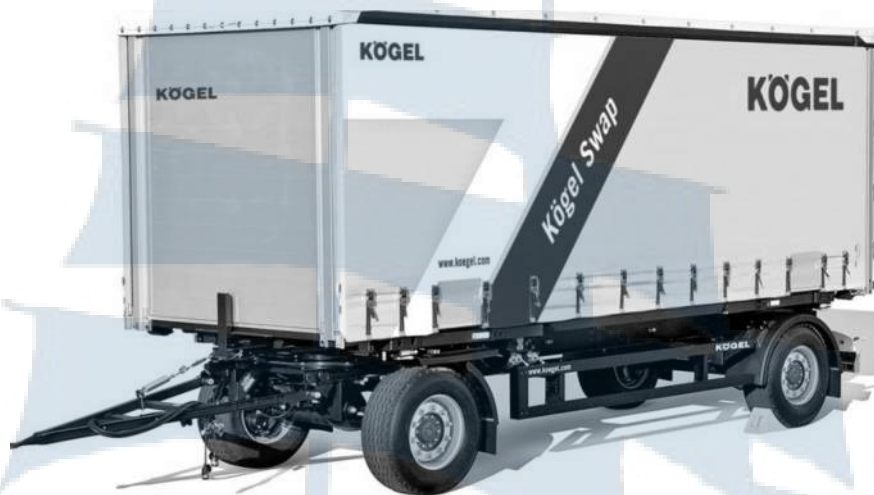
Рис. 11. Кузов Kogel Swap на прицепе Kogel Combi
