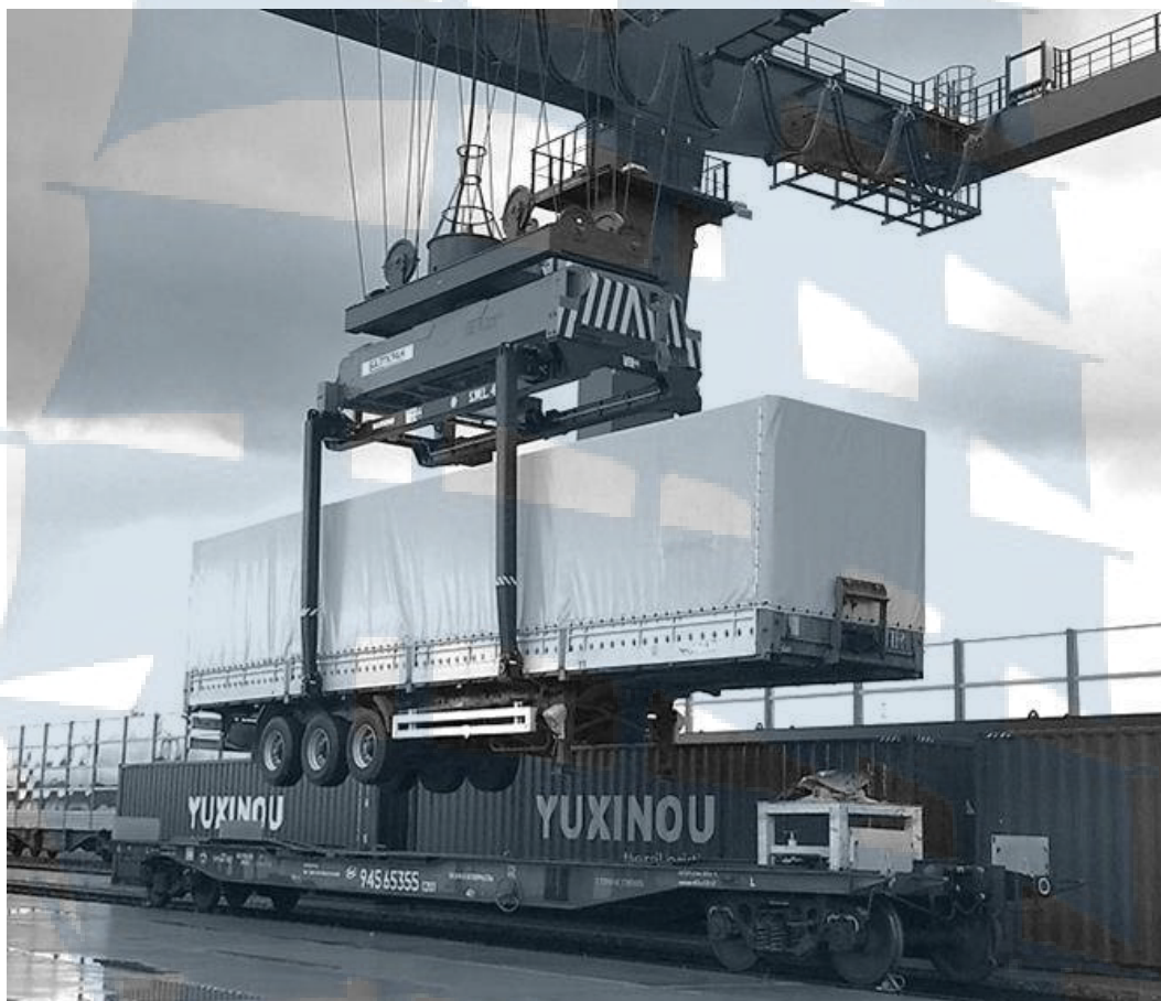
Рис. 33. Погрузка контрейлера на платформу по технологии Lo – Lo
