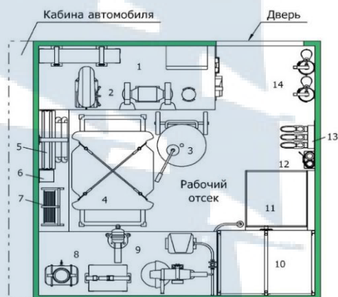
Рис. 77. Машина ремонтно-эвакуационная колесная легкая РЭМ-КЛ: 1 – верстак правый с ящиками для инструментов; 2 – оборудование верстака правого; 3 – установка С223-1; 4 – контейнер; 5 – стол выносной, стул складной (2 шт.); 6 – навесной ящик (для документов); 7 – катушка шланговая КШУ; 8 – верстак левый с ящиками для инструментов; 9 – оборудование верстака левого; 10 – шкафы; 11 – сиденье; 12 – гамак подвесной; 13 – аптечка; 14 – огнетушители
