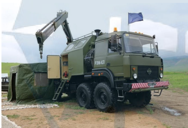
Рис. 77. Машина ремонтно-эвакуационная колесная легкая РЭМ-КЛ: 1 – верстак правый с ящиками для инструментов; 2 – оборудование верстака правого; 3 – установка С223-1; 4 – контейнер; 5 – стол выносной, стул складной (2 шт.); 6 – навесной ящик (для документов); 7 – катушка шланговая КШУ; 8 – верстак левый с ящиками для инструментов; 9 – оборудование верстака левого; 10 – шкафы; 11 – сиденье; 12 – гамак подвесной; 13 – аптечка; 14 – огнетушители
