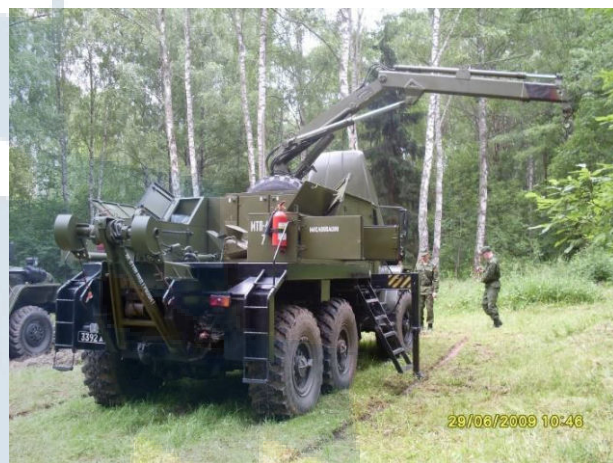
Рис. 76. Мастерская технической помощи МТП-А2
