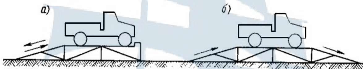
Рис. 12. Схема устройства эстакад: а – тупиковая; б – прямоточная
