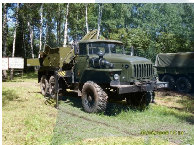
Рис. 76. Мастерская технической помощи МТП-А2
