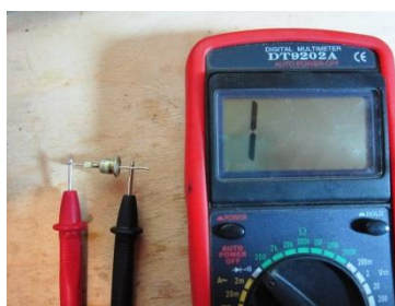
Рис.3. Проверка работы диода в прямом (а, б) и обратном (в, г) направлениях
