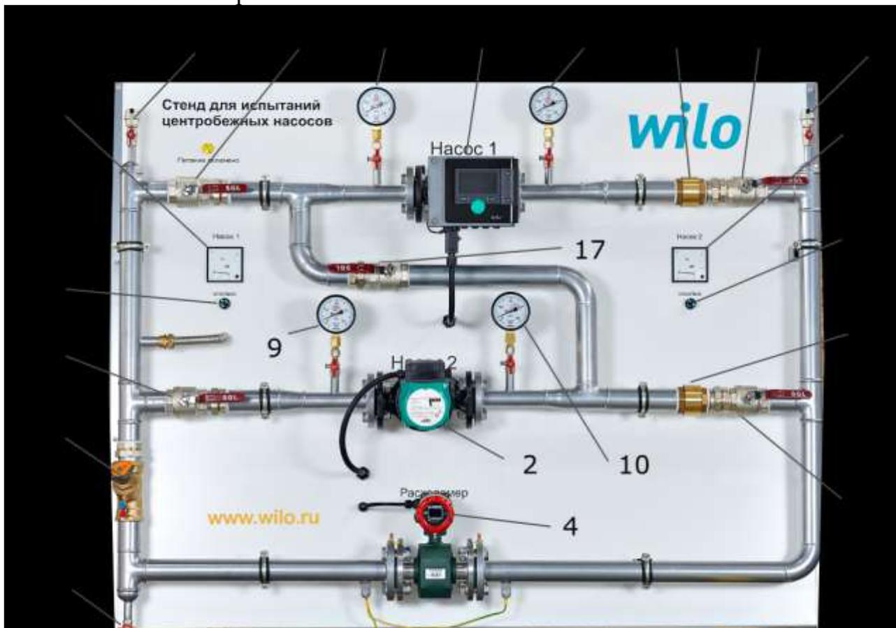
Рисунок. 1. Стенд для испытаний центробежных насосов
