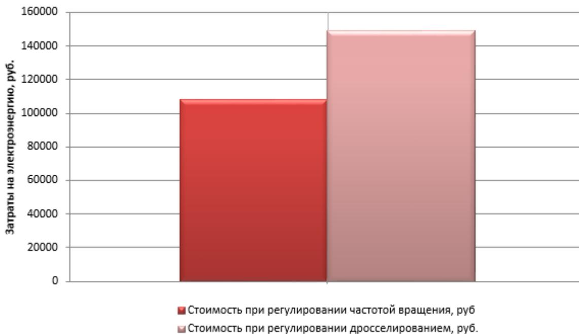
Рисунок. 19. Разность годовых затрат на электроэнергию при различных способах регулирования
