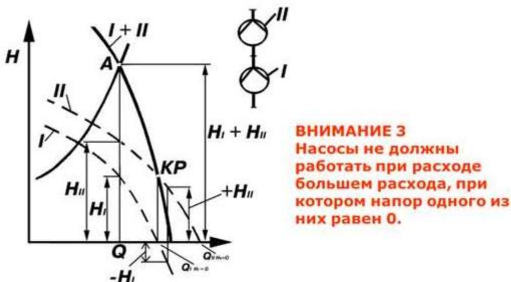
Рисунок. 7. Последовательная работа насосов с разными характеристиками
