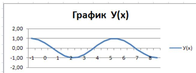
**Рисунок 10** График функции Y(x) = Cos(x+1)
