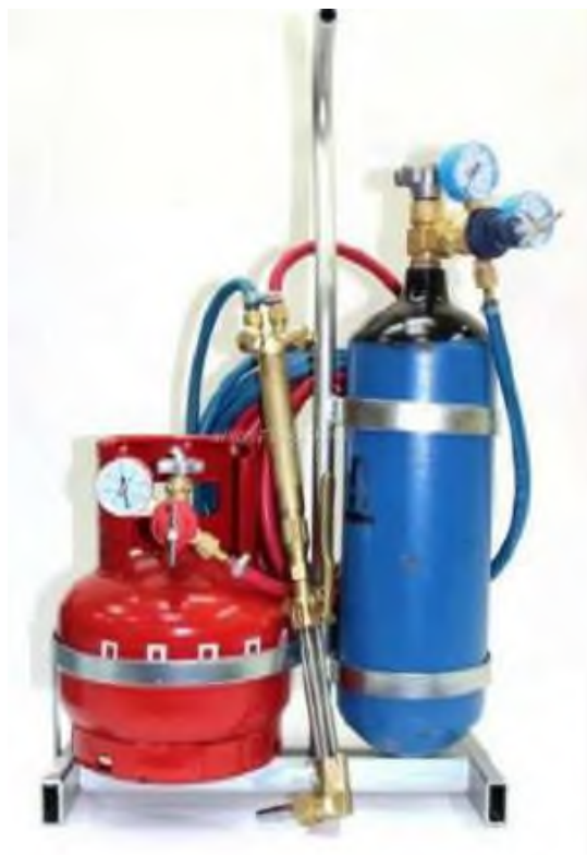
Рисунок 17. Станция для создания смеси «пропан-кислород».
