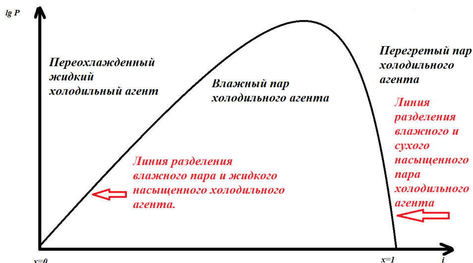
Рисунок 21. Области состояния хладагента в диаграмме P_i .
