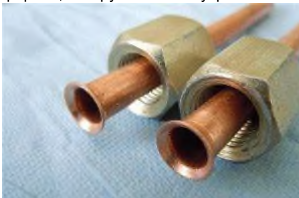
Рисунок 16. Пример правильно развальцованных трубопроводов.
