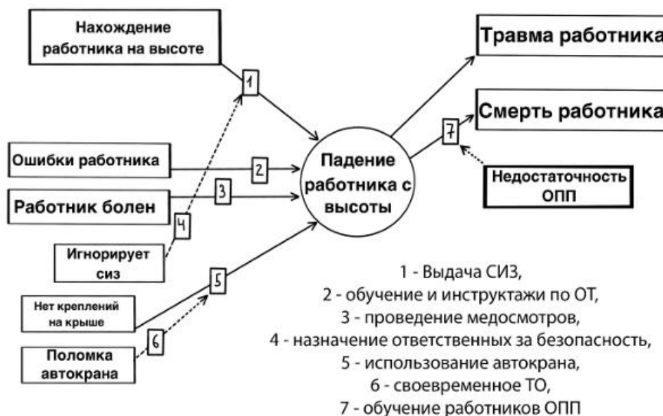
Рисунок 1 – Анализ риска опасного события - падение работника при уборке снега с крыши с использованием автокрана методом «галстук-бабочка»
