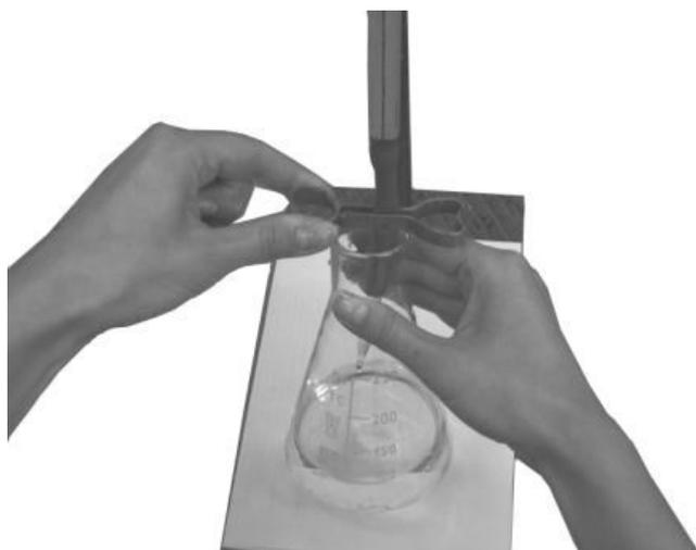
Рисунок 13 – Положение рук при титровании без магнитной мешалки
