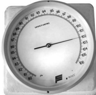
Рисунок 39 – Барометр-анероид: внешний вид
