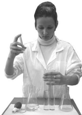
Рисунок 29 – Положение рук во время колориметрирования проб в парных цилиндрах
