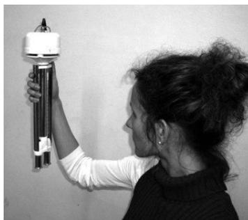
Рисунок 38 – Положение психрометра при снятии отсчета
