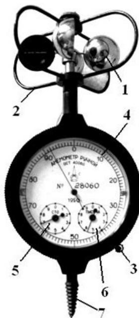
Рисунок 43 – Ручной чашечный анемометр: 1 – полушария; 2 – металлическая защита; 3 – арретир; 4-6 – шкалы, 7 – стержень с винтовой нарезкой
