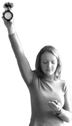
Рисунок 45 – Положение пальцев при работе с анемометром
