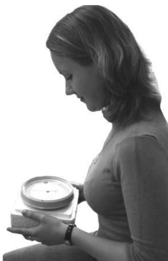
Рисунок 41 – Снятие отсчета с барометра-анероида
