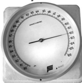
Рисунок 39 – Барометр-анероид: внешний вид
