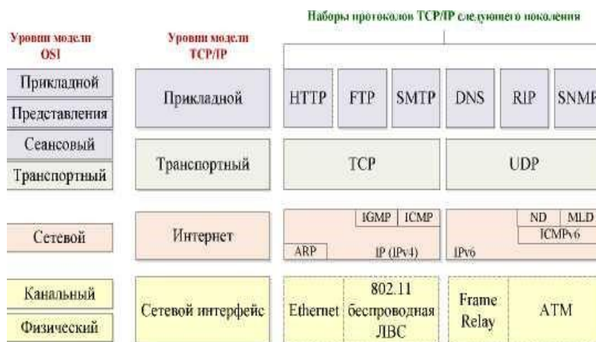
Рисунок 23. Протоколы, используемые на четырех уровнях модели TCP/IP в сетях Microsoft
