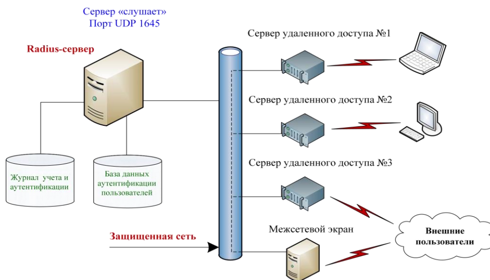
Рисунок 20. Архитектура сервера аутентификации RADIUS
