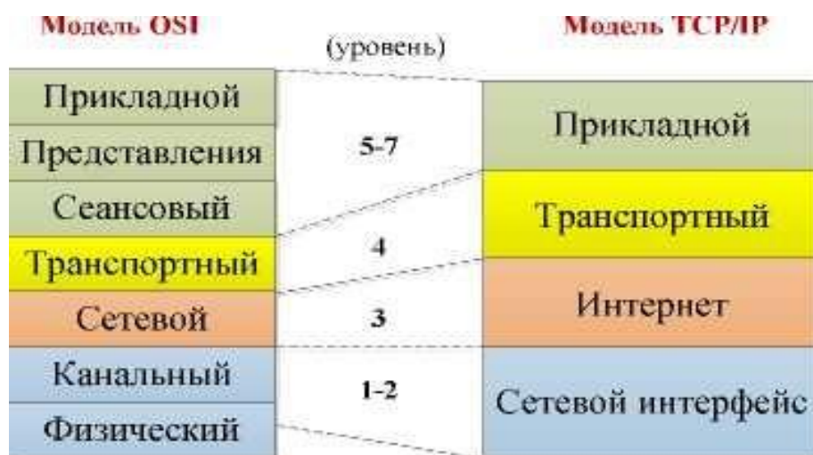
Рисунок 22. Соответствие уровней TCP/IP и OSI
