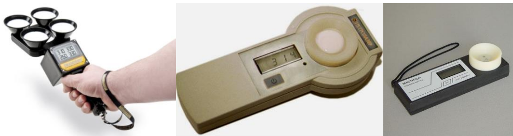
Рисунок 134 – Приборы для определения электропроводности молока
