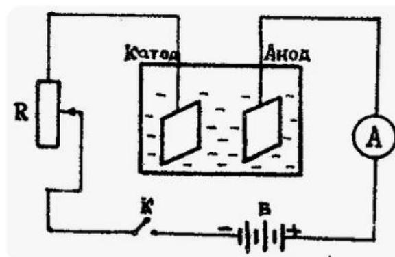
14. После проверки цепи преподавателем, заметить время по часам с секундной стрелкой, замкнуть ключ. Быстро установить реостатом силу тока 1-2 А.
