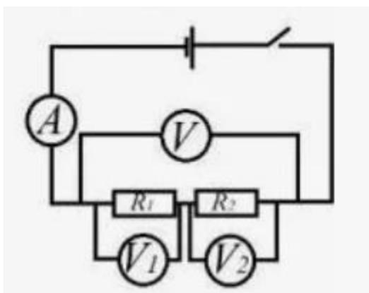
7. Изменить схему установки так, чтобы она позволяла измерить напряжение на втором и первом сопротивлении. Схему зарисовать в тетрадь
