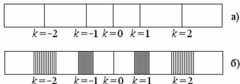
Рис. 2. Вид картины, получаемой с помощью дифракционной решетки:
