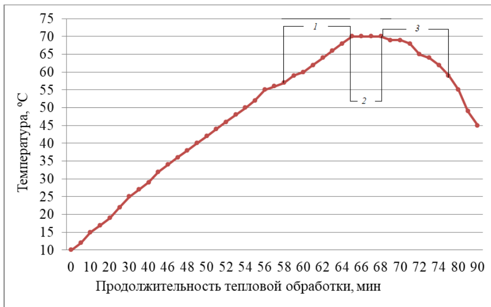
Рисунок 11.2 – Термограмма изменений температуры внутри батона вареной колбасы диаметром 70 мм: 1,2 и 3 – соответственно фазы нагревания, выдержки и охлаждения
