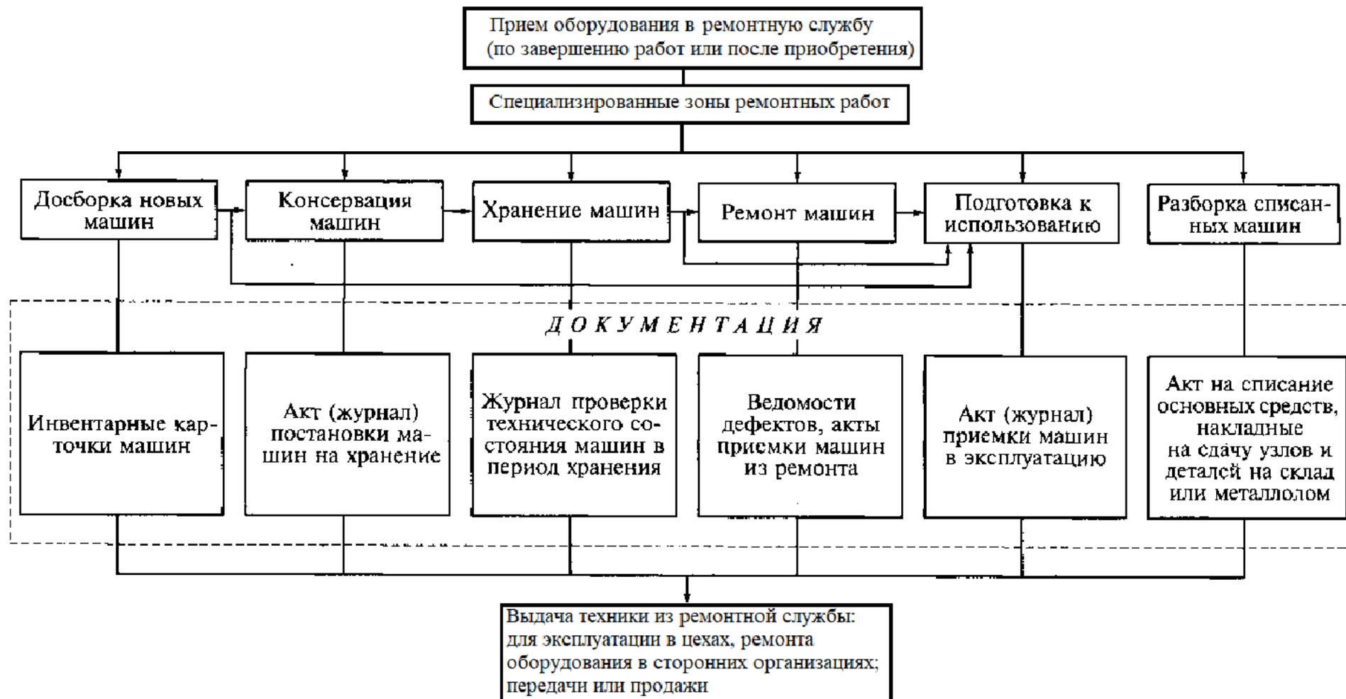
Рисунок 4.1 – Технологическая схема проведения работ в специальных ремонтных службах
