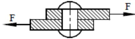
Рисунок 5.8 – Расчетная схема заклепочного соединения
