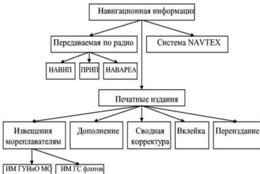
Рисунок номер рисунка – Схема передачи навигационной информации
