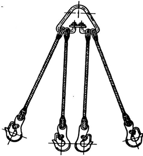
Рисунок 1 - Многоветвевой строп с крюками, снабженными предохранительными замками
