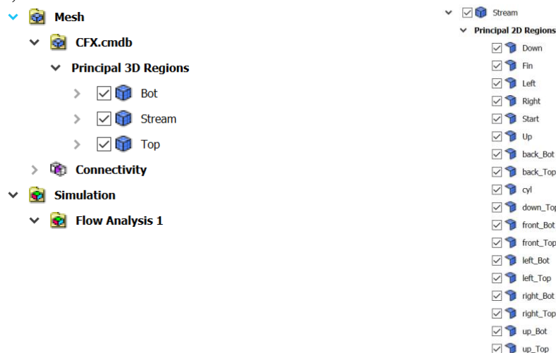
Рисунок 39 – Трехмерные тела и двумерные поверхности в Дереве модели
