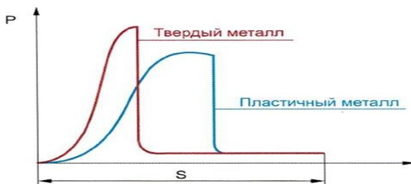
Рисунок 5.5 – Характер изменения силы вырубki по перемещению пуансона при оптимальном зазоре Z
