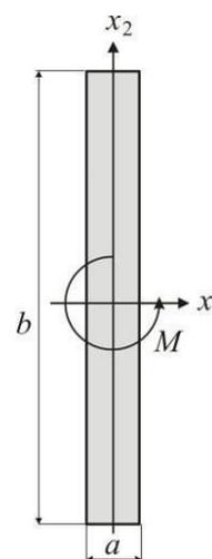
Даны три тонкостенных профиля, имеющие одинаковые площади. Считая известными крутящий момент и свойства материала, найти величину максимального касательного напряжения для каждого профиля. Определить самый жесткий профиль.
