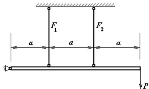
Симметричная система трех стержней одинаковой длины нагружена силой  $P$ . Площади поперечных сечений –  $F_1$  и  $F_2$ . Считая характеристики материала известными, найти напряжения в стержнях в состоянии установившейся ползучести, используя теорию старения.
