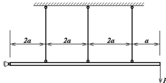
одинаковых стержнях сечением  $F$ . Считая характеристики материала известными, найти напряжения в стержнях в состоянии установившейся ползучести, используя теорию старения.
