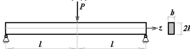
материала с пределом текучести  $\sigma_T$  установлена на две шарнирные опоры. Считая величину силы  $P$  равной  $5/6$  предельной, найти и изобразить границы пластической зоны.
