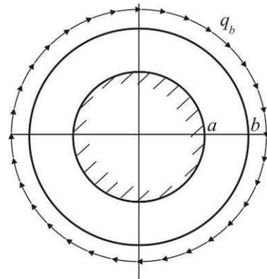
Составной цилиндр образован путем посадки с радиальным натягом  $\delta$  двух цилиндров  $a \leq r \leq b$  и  $b \leq r \leq c$ , изготовленных из разных материалов и имеющих одинаковые объемы. Найти величину контактного давления и напряжения в цилиндрах. Считая коэффициенты Пуассона двух материалов одинаковыми, а модули упругости различными, обосновать выбор варианта более прочной посадки.
