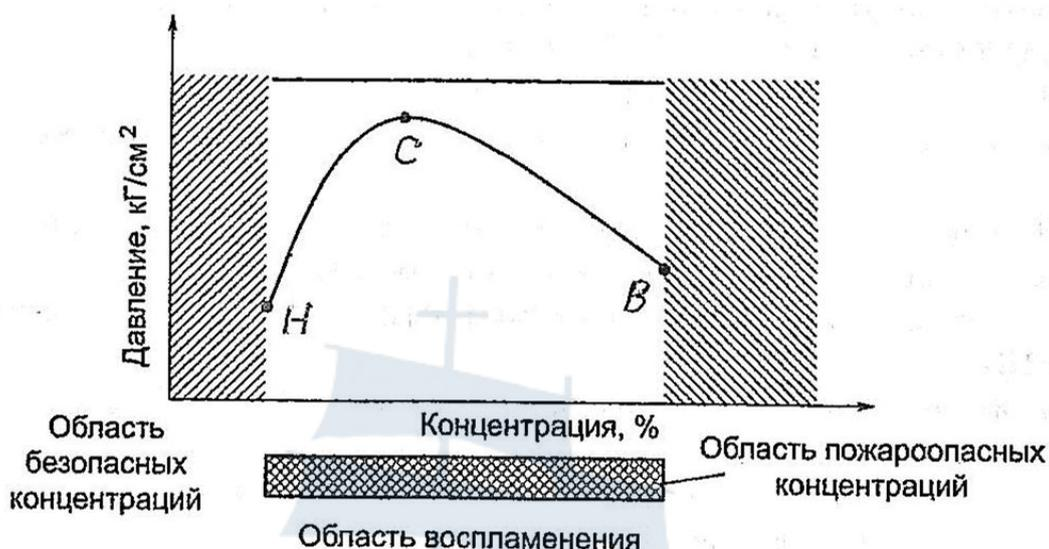
Рис. 3.1. Зависимость давления горящих газопаровоздушных смесей от концентрации горючего вещества в смеси с воздухом
