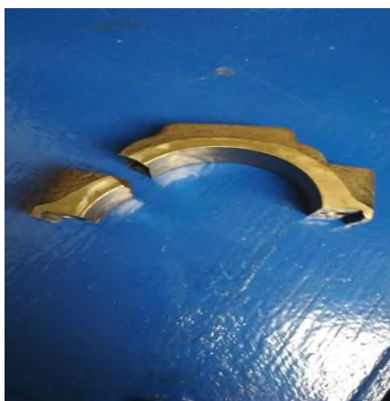
Рисунок 60. Фотография разрушенной верхней головки шатуна.
