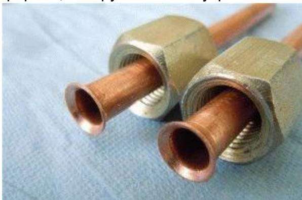
Рисунок 16. Пример правильно развальцованных трубопроводов.
