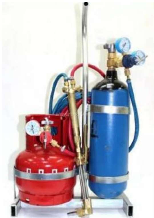
Рисунок 17. Станция для создания смеси «пропан-кислород».
