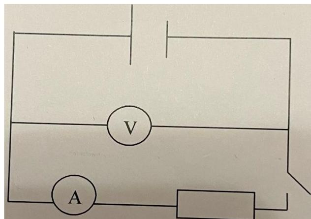
Исходные данные и материалы: источник тока, амперметр, вольтметр, резистор, ключ, соединительные провода.
