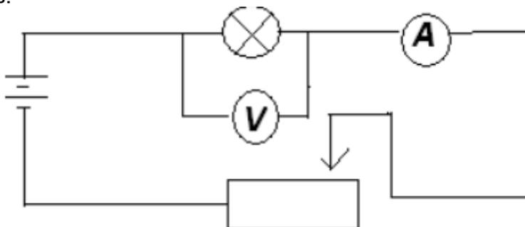
4. После проверки цепи преподавателем ключ замкнуть. С помощью реостата установить наименьшее значение напряжения. Снять показания измерительных приборов.
