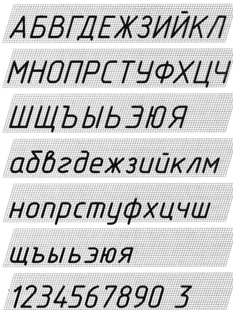
Рисунок 15 – Образец стандартного чертежного шрифта типа Б с наклоном (согласно ГОСТ 2.304-81)
