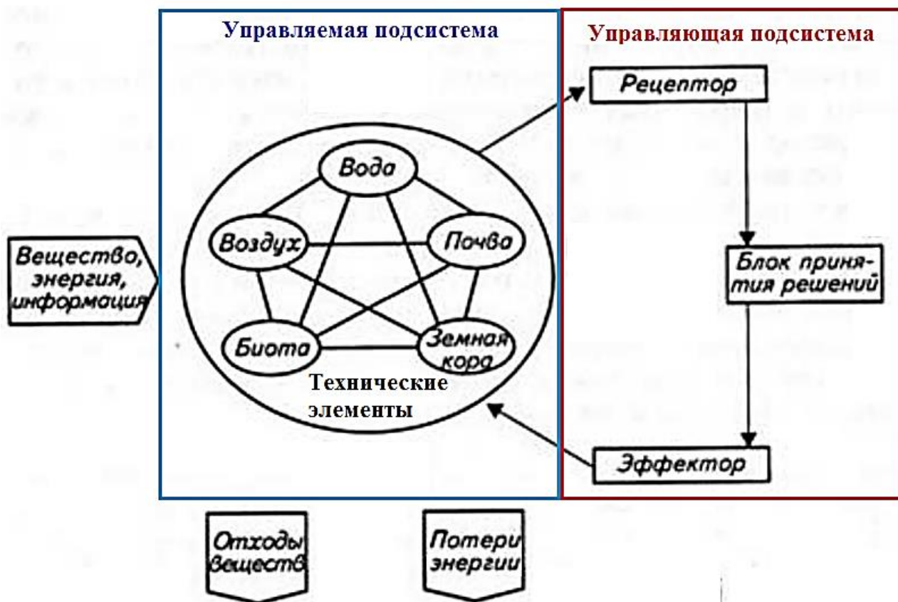
Рисунок 5.1 – Схема управления ПТК
