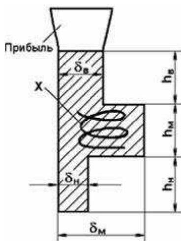
Рисунок 22 – Схема установки внутреннего холодильника (X) в массивном узле отливки [3, с. 205]
