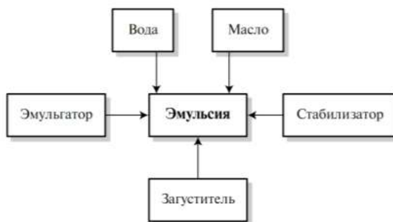
Рисунок 3 - Схема создания эмульсии
