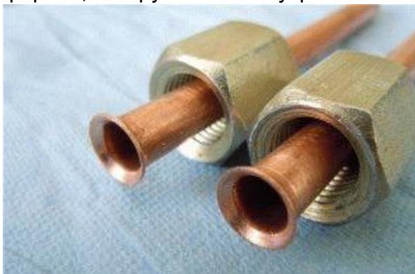
Рисунок 16. Пример правильно развальцованных трубопроводов.
