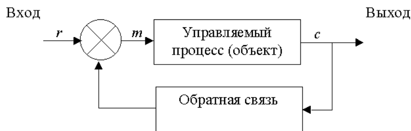
Рисунок 1.2 – Схема управления с обратной связью (простая замкнутая система)
