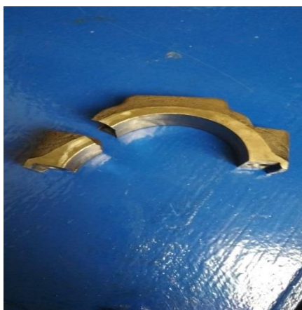
Рисунок 60. Фотография разрушенной верхней головки шатуна.
