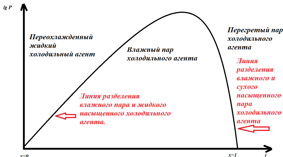
Рисунок 21. Области состояния хладагента в диаграмме Pi.
