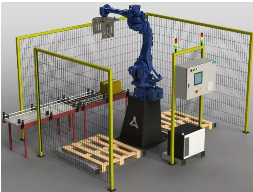
Рисунок 3 – Общий вид мехатронного участка паллетирования коробок массой до 20 кг на базе промышленного робота
