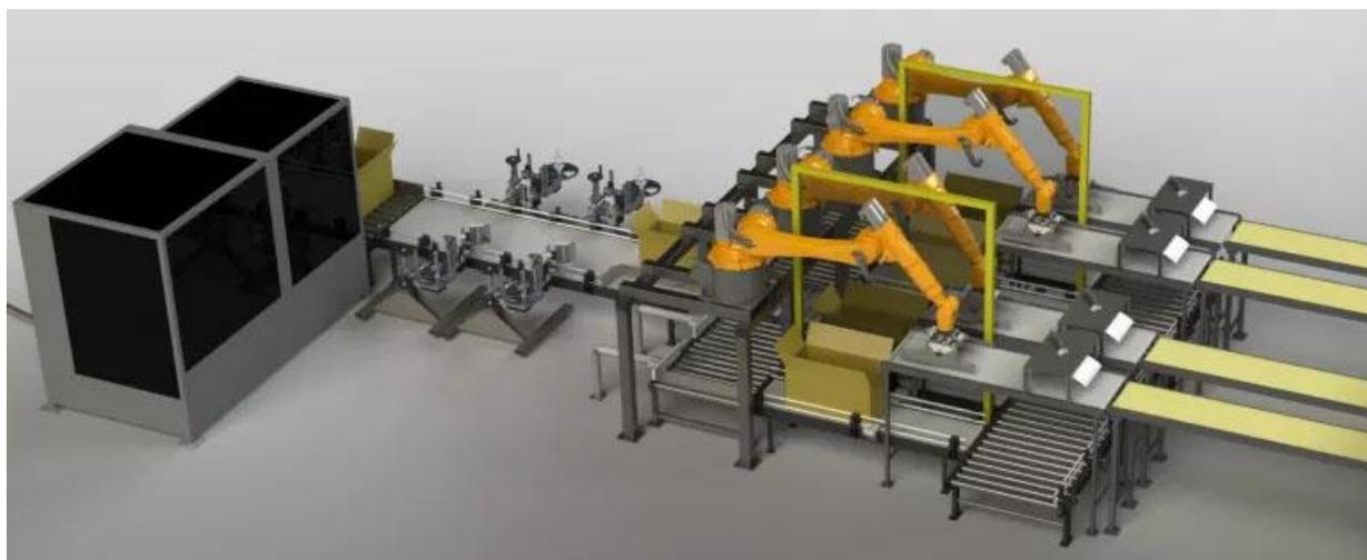
Рисунок 4 – Общий вид мехатронного участка укладки лотков с яйцами в картонные ящики на базе промышленного робота
