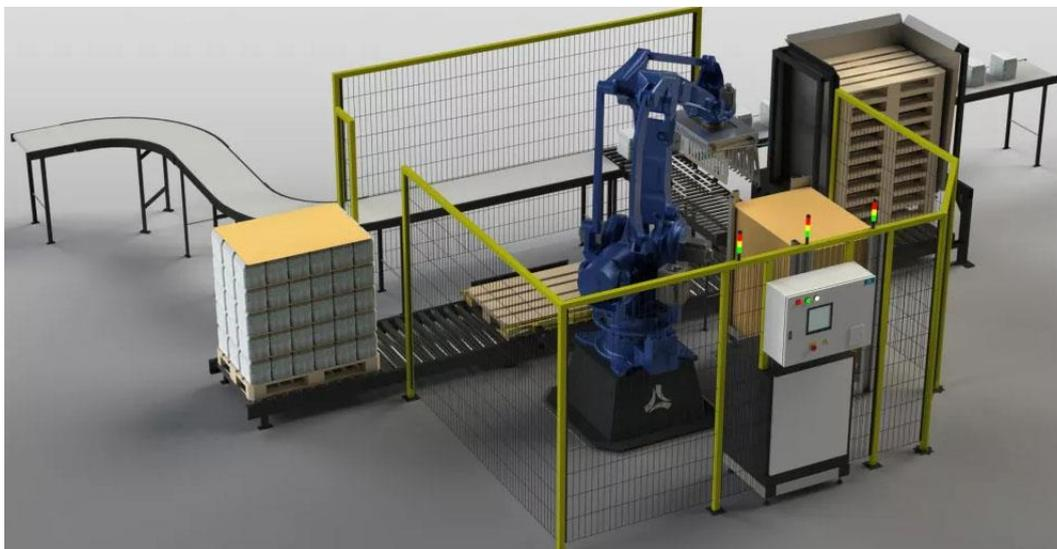
Рисунок 2 – Общий вид мехатронного участка паллетизации паков с водой 0,5 л и 1,5 л массой до 30 кг на базе промышленного робота
