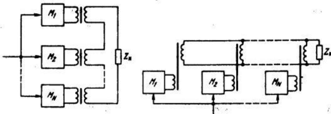
Однако при таком суммировании сохраняются недостатки параллельного и двухтактного включений ламп и транзисторов: требуются идентичность и синфазность работы отдельных генераторов, симметрия схемы, сохраняется взаимное влияние и, значит, резко снижается надежность работы всего устройства.
