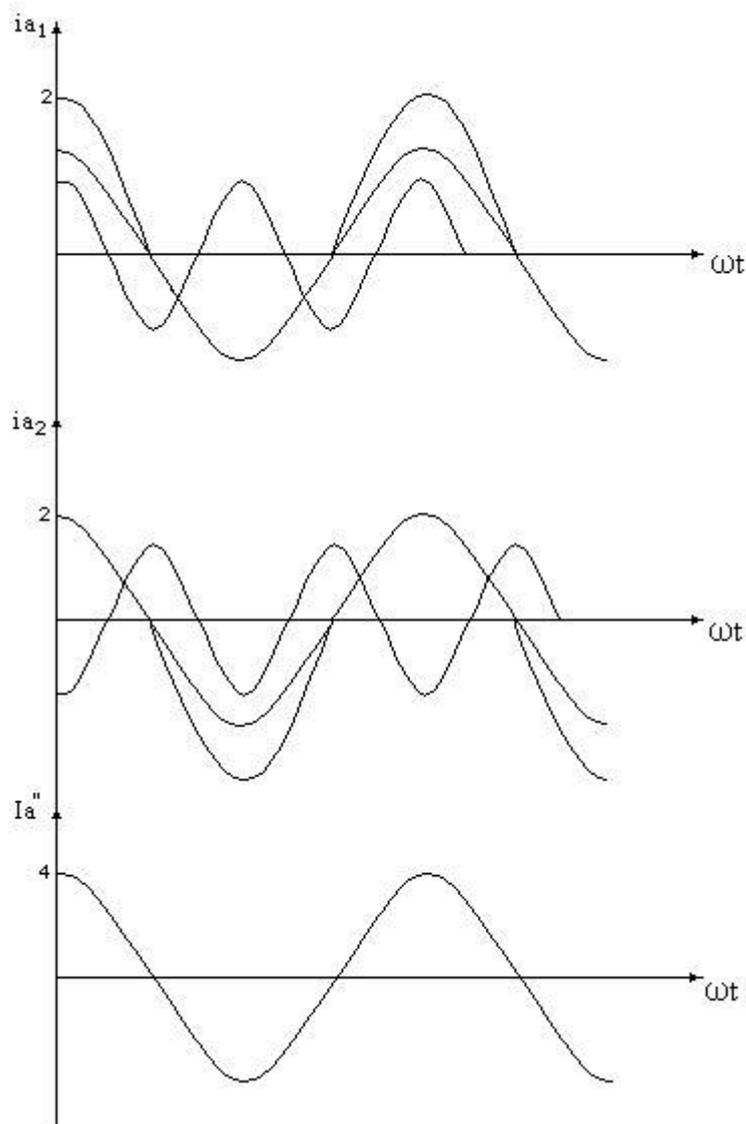
Выходные каскады, как и все каскады передатчика, работают в режиме колебаний второго рода. Ток через нагрузку протекает в течение одного полупериода от каждого усилительного прибора. Эти токи текут навстречу друг другу и представляют косинусоидальные импульсы, которые могут быть разложены в ряд Фурье на постоянную составляющую и сумму гармоник. Постоянная составляющая и все четные гармоники взаимоуничтожаются. Если выбрать режим класса В, для
