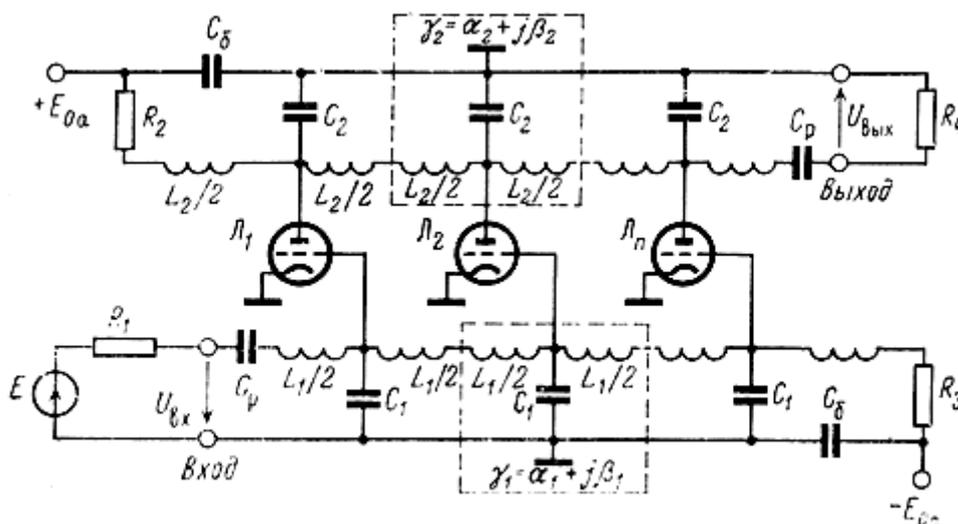
*Рис. 1.1. Принципиальная схема каскада УРУ на триодах по схеме с общим катодом*
