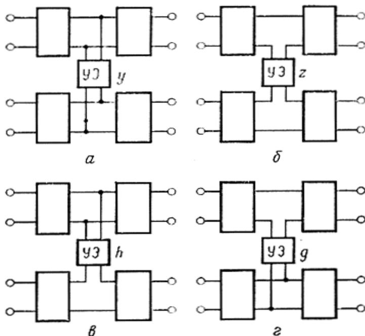
Рис. 1.3. Структурные схемы основной секции с различным включением УЭ в передающие линии: а) параллельным; б) последовательным; в) последовательно-параллельным; г) параллельно-последовательным
