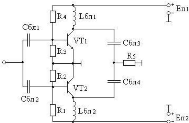
Можно осуществлять сложение мощностей нескольких ВЧ генераторов, выполненных в виде идентичных модулей и подключаемых параллельно либо последовательно с помощью широкодиапазонных трансформаторов или резонансных ЦС к общей нагрузке  $Z_n$ .
