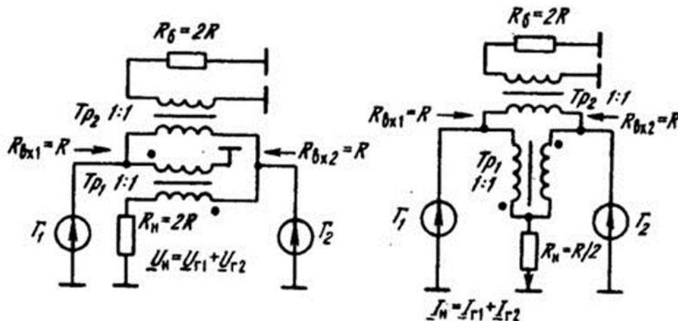
Можно осуществлять сложение мощностей нескольких ВЧ генераторов, выполненных в виде идентичных модулей и подключаемых параллельно либо последовательно с помощью широкодиапазонных трансформаторов или резонансных ЦС к общей нагрузке  $Z_n$ .
