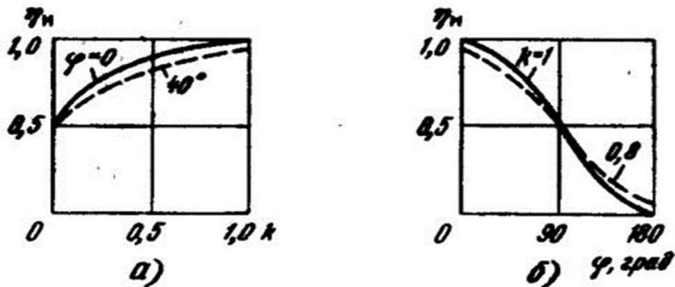
Видно, что КПД мостовой схемы остается высоким даже в том случае, когда токи неточно равны по амплитуде и неточно синфазны. Если амплитуды различаются не более чем на 20 %, а сдвиг фаз не превышает 40%, КПД снижается до 0,87, т. е. только 13 % суммарной мощности теряется на сопротивлении  $R_B$ .
